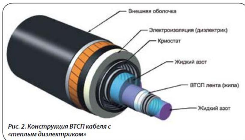
В состав ВТСП КЛЭП входит не только кабель, но и система криогенного обеспечения (для охлаждения кабеля жидким азотом), концевые и соединительные муфты (как и для обычных кабелей), система мониторинга. Поэтому в связи со сложностью всех элементов (в том числе в составе самого кабеля), ни одна компания в мире пока не может реализовать проект только своими силами, и каждый существующий образец кабеля выполнялся несколькими фирмами одновременно.
