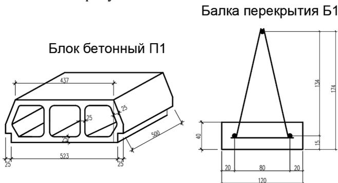
Рисунок 1 – Размеры элементов перекрытия
