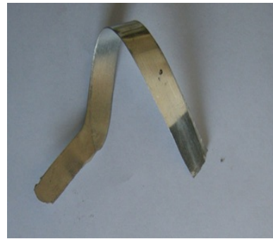
Рисунок 2 – Общий вид лигатуры на основе олова: а – экструзии; б – прокатки
