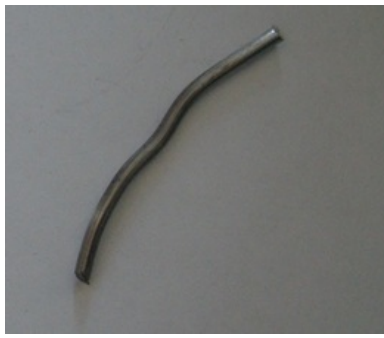
Рисунок 2 – Общий вид лигатуры на основе олова: а – экструзии; б – прокатки
