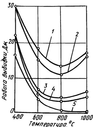
Рис. 2. Зависимость работы выбивки образцов от температуры прогрева и содержания полифосфата натрия, массовая доля, %:
