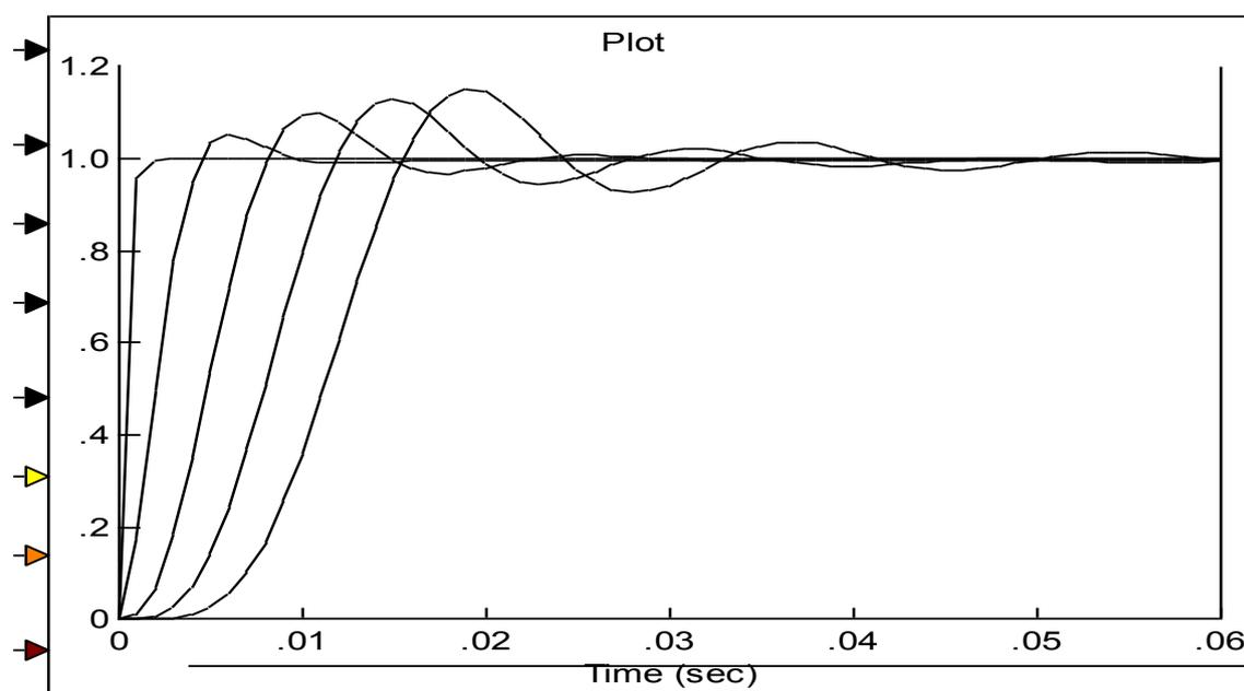
В качестве примера моделируется низкочастотный фильтр Чебышева с погрешностью 0,1 и частотой среза 50 Гц. На рисунке представлены переходные характеристики для фильтров 1, 2, 3, 4 и 5 порядков. Как видно из рисунка - длительность переходного процесса прямо пропорциональна порядку фильтра и для фильтров выше 3-го порядка составляет больше периода промышленной частоты.
