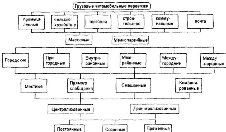
Рис. 4.3. Классификация автомобильных перевозок
