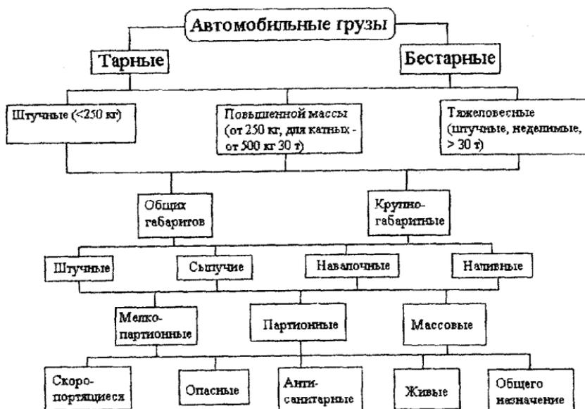
Рис. 4.5. Классификация грузов, принятая на автомобильном транспорте
