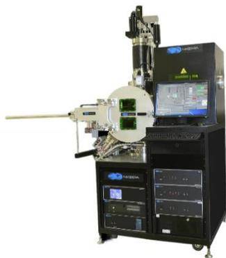
Рис. 2. Установка для лазерной абляции в вакууме
