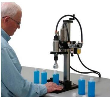
Рис. 1. Пневматический укупорщик
