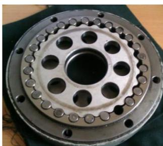
Рисунок 1. Планетарно-кривошипный механизм с цевочным зацеплением
