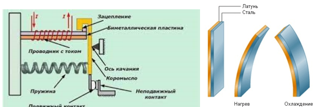
Рис. 8. Биметаллическое тепловое реле
