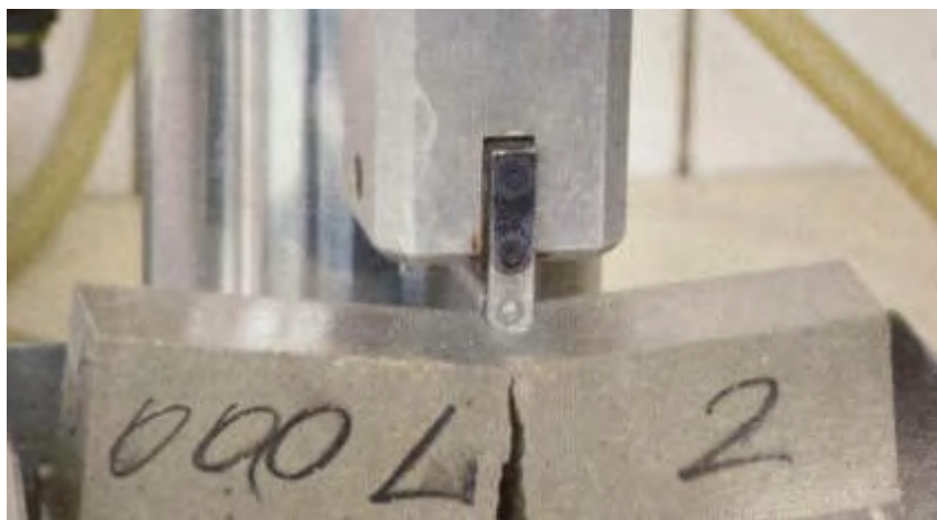
Рис. 9.9. Испытание цементной палочки на изгиб
