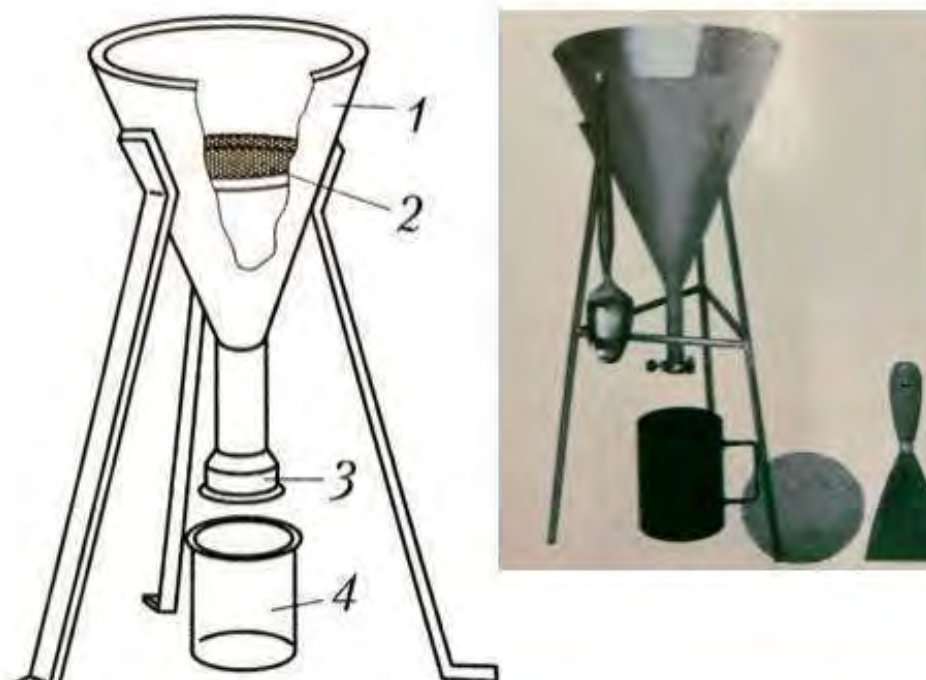
Рис. 9.6. Прибор для определения насыпной плотности цемента. 1 – воронка, 2 – подставка, 3 – задвижки, 4 – мерный сосуд, 5 – сосуд.
