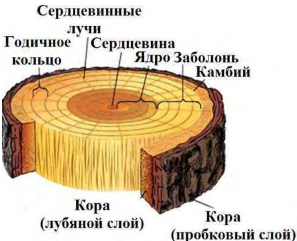
Рис.3.7. Поперечный разрез древесины
