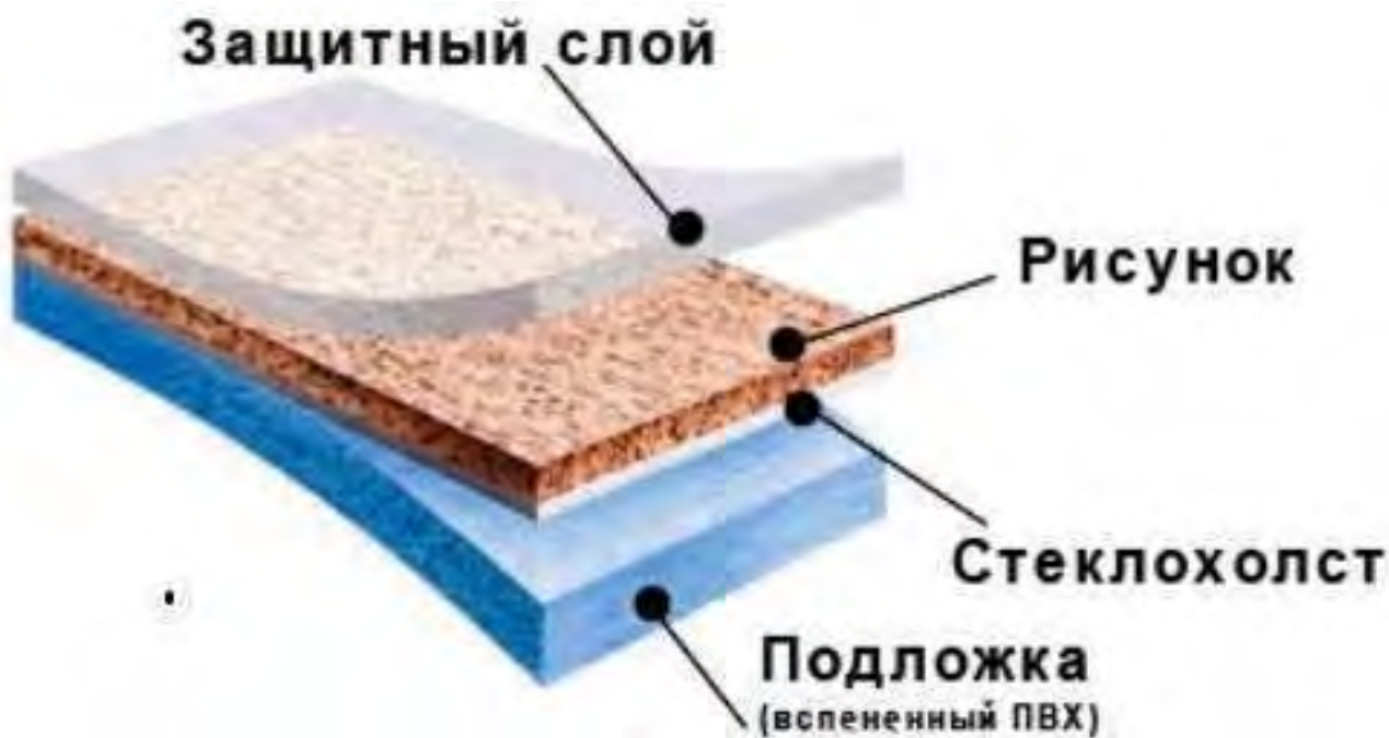
Рис. 16.8. Структура гетерогенного линолеума
