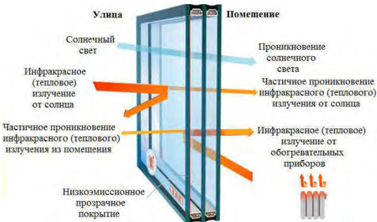
Рис. 6.9. Схема работы стеклопакета с энергосберегающим стеклом
