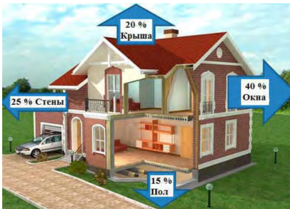
Рис. 17.2. Потери тепла через ограждающие конструкции
