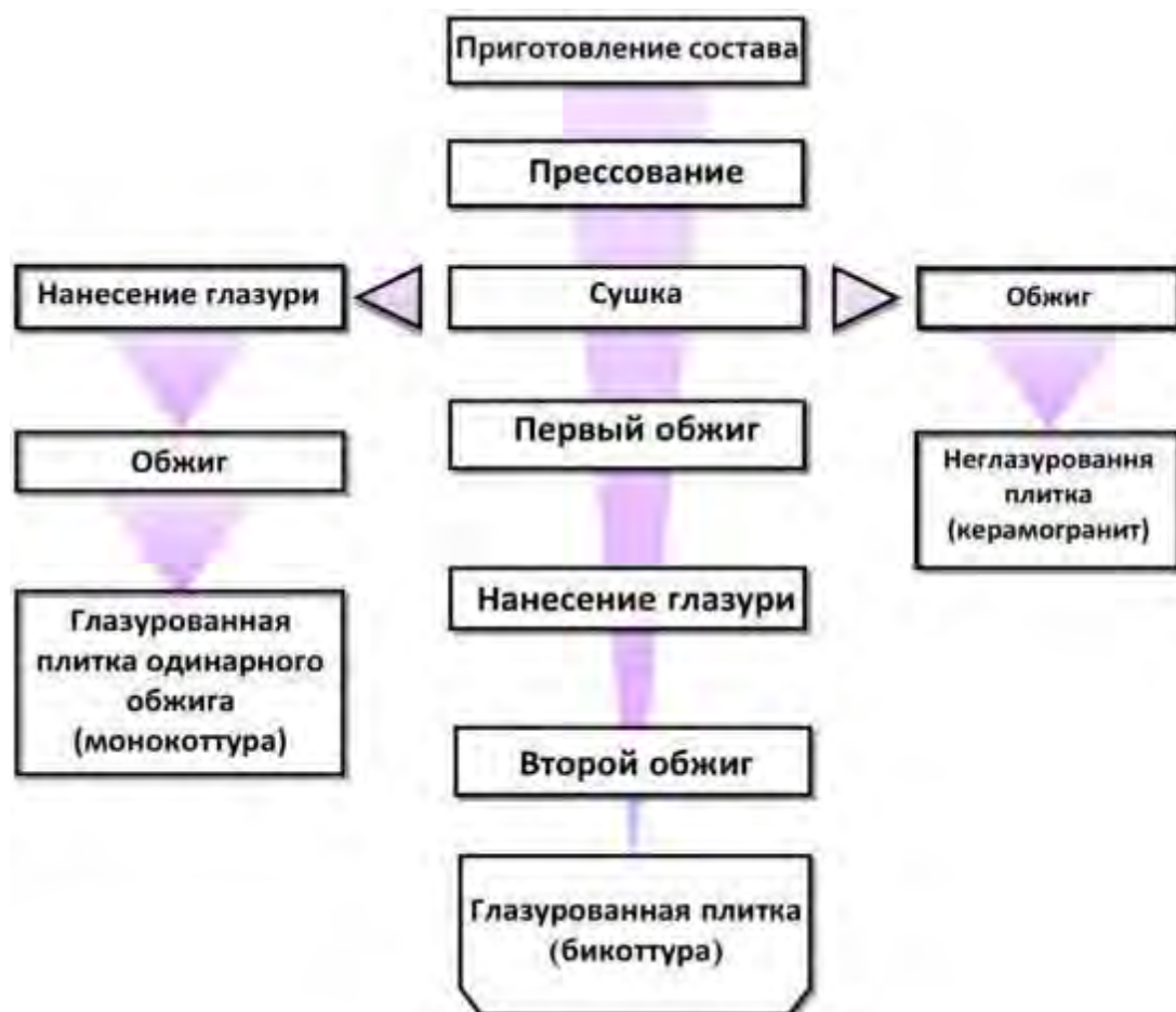
Рис. 5.10. Схема технологического процесса производства керамической плитки
