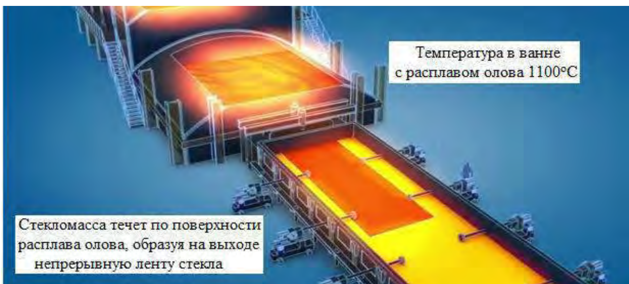
Рис.6.1. Получение стекла флоат-способом
