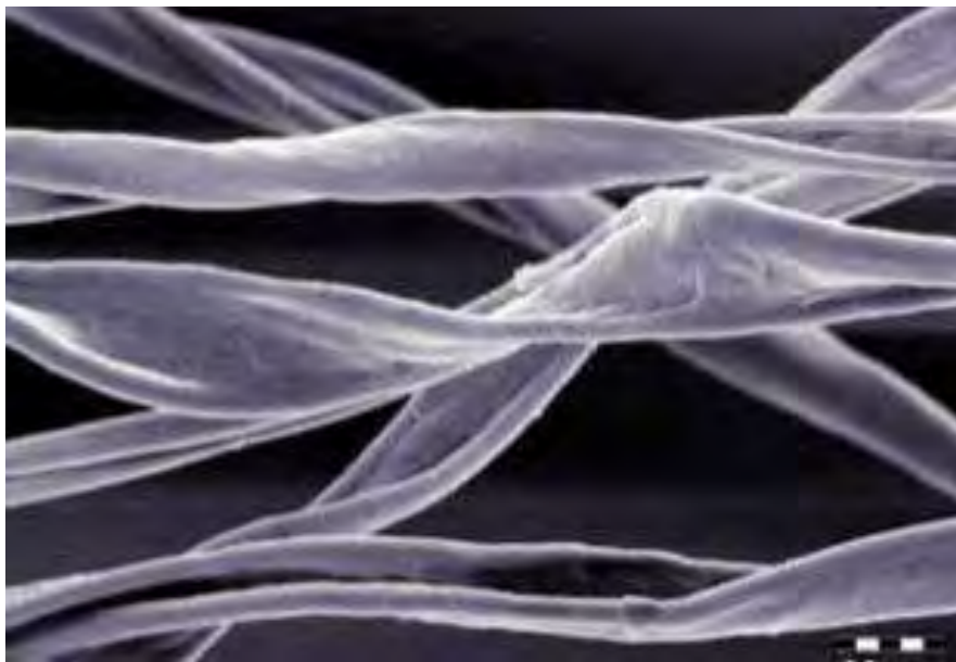
Рис.3.4. Пучок целлюлозных волокон под электронным микроскопом
