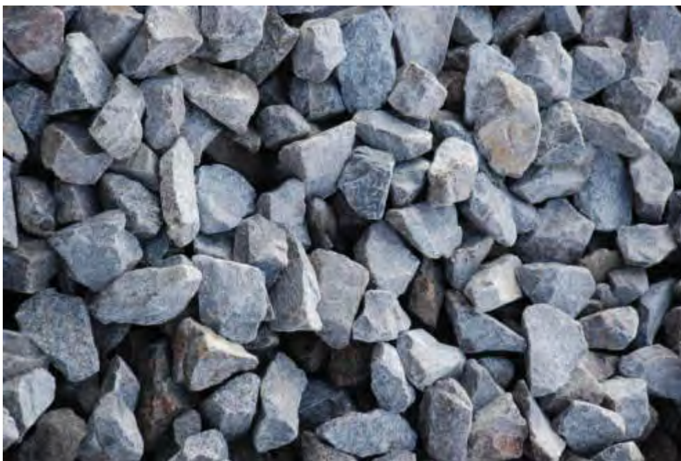
Рис. 11.3. Щебень гранитный фр. 20-40 мм
