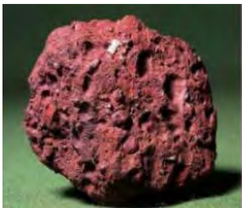
Рис.7.6. Сырье для получения алюминия
