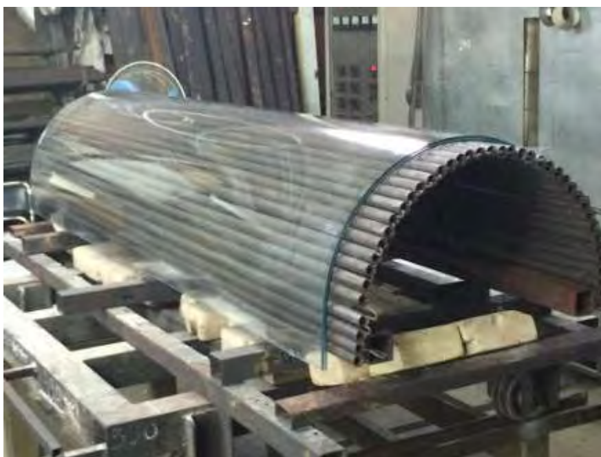
Рис.6.12. Получение моллированного стекла (гнутого)
