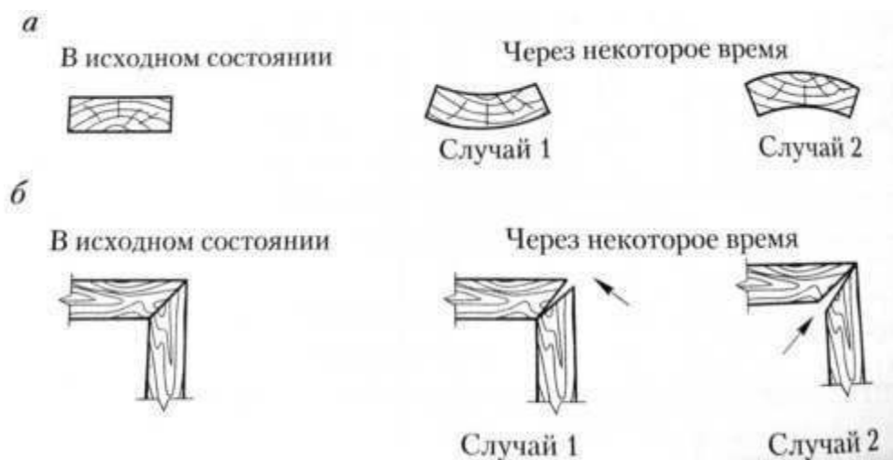
Рис. 4.3. Характерные деформации и коробление пиломатериалов
