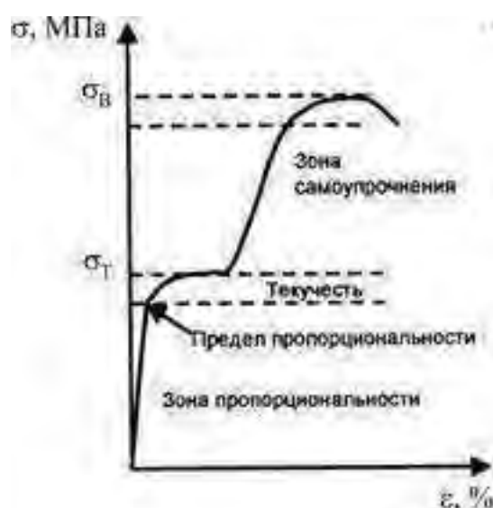
Рис. 5. Диаграмма растяжения стальной арматуры
