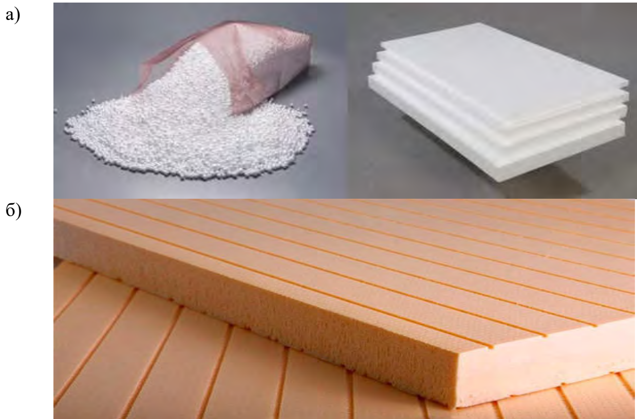
Рис. 17.12. Пенополистирол: а – экспандированный, б – экструзионный
