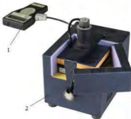
Рис. 16.1 Общий вид прибора ИТП-МГ4: 1 – электронный блок, 2 – установка
