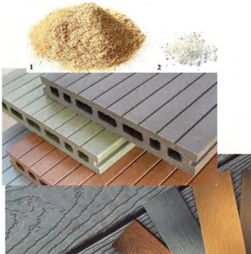
Рис.4.42. Компоненты ТДПК (1 –измельченная древесина, 2 – полимерное связующее) и готовые изделия
