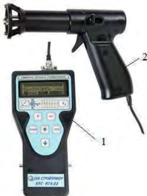
Рис. 13.1. Электронный измеритель прочности бетона ИПС-МГ4: 1 – блок электронный; 2 – склерометр (преобразователь).
