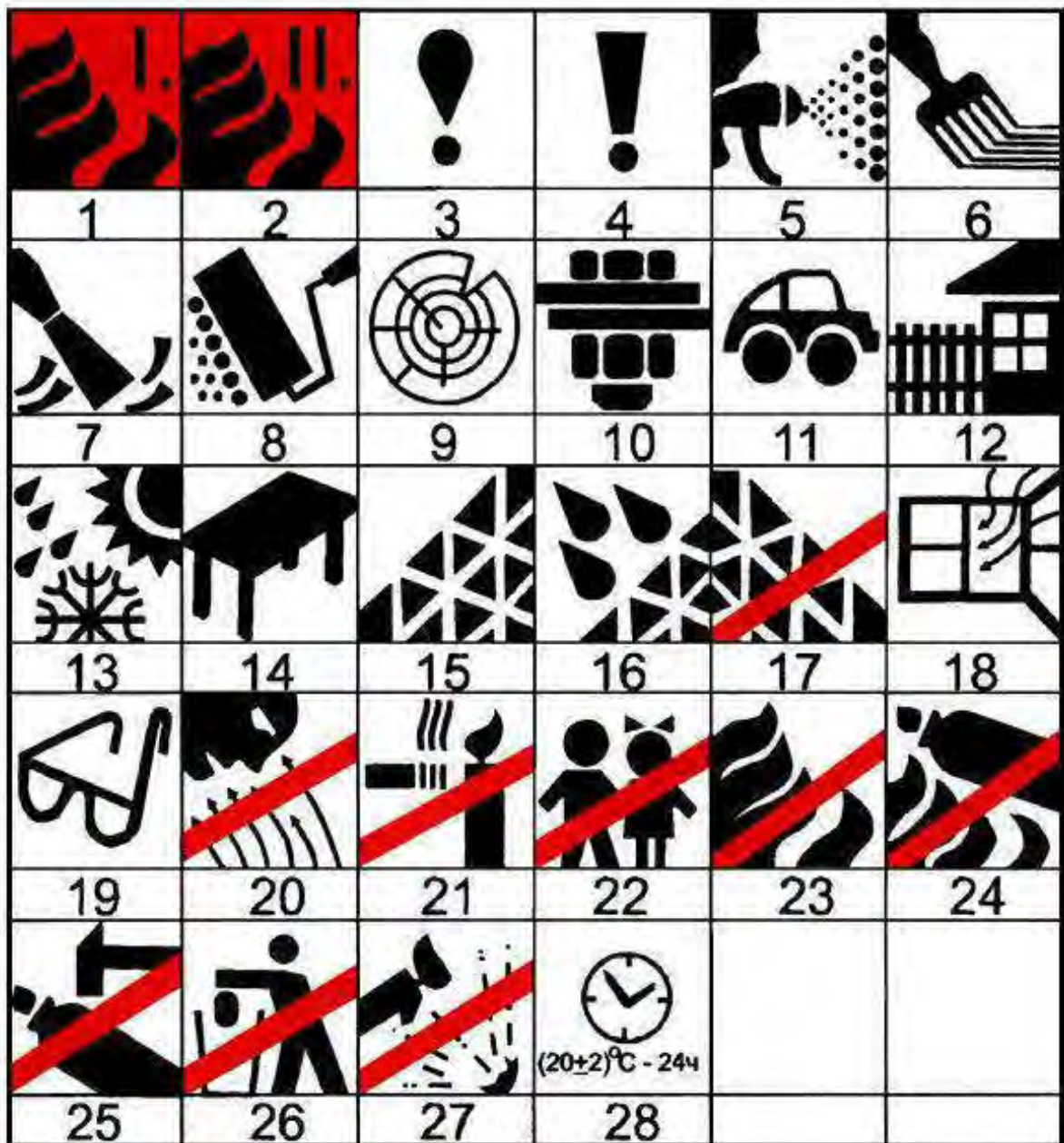
Рис. 21.3 Пиктограммы на упаковке ЛКМ: 1 - горячая жидкость; 6 - нанесение кистью; 12 - для наружных работ; 14 - для внутренних работ; 20 - опасные испарения; 21 - не применять открытое пламя, не курить; 22 - беречь от детей; 23 - сжигание воспрещается; 28 - время высыхания (24 ч)
