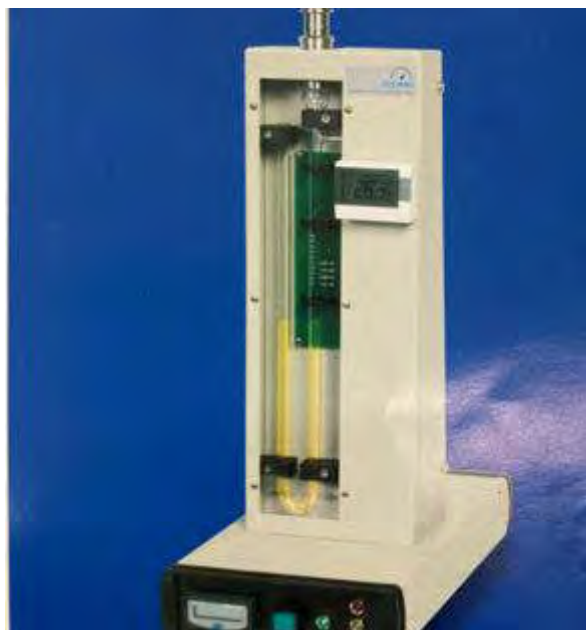
Рис.9.6. Прибор Блейна (определение удельной поверхности)
