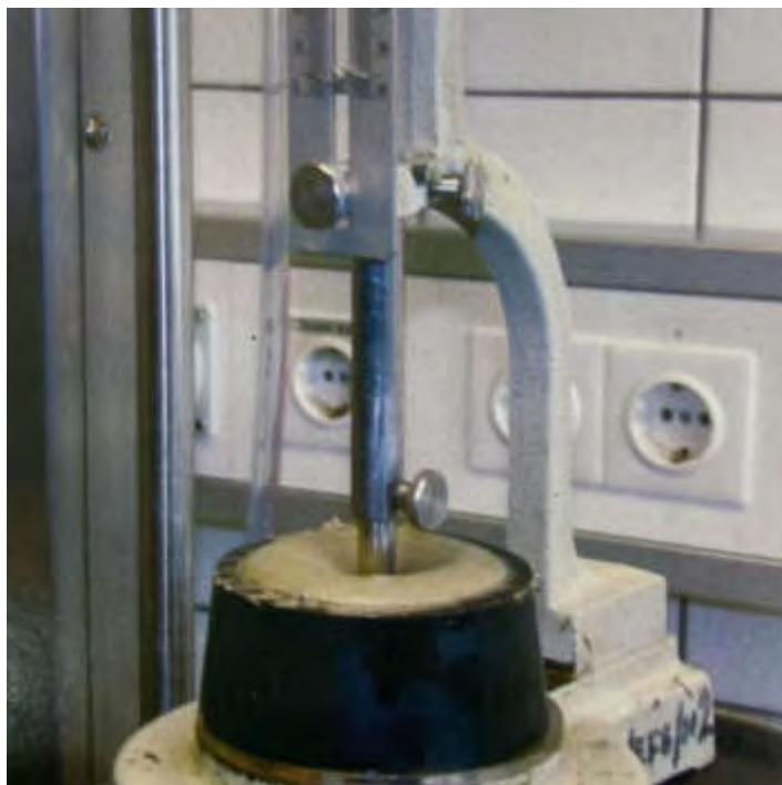
Рис, 9.3. Определение нормальной густоты. Погружение песка на глубину 6 \pm 2 мм
