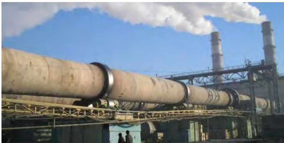
Рис. 9.3. Печь для обжига сырьевой смеси
