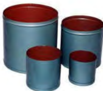
Рис. 4. Мерные сосуды емкостью 10, 5, 2 и 1 литр для определения насыпной плотности заполнителей
