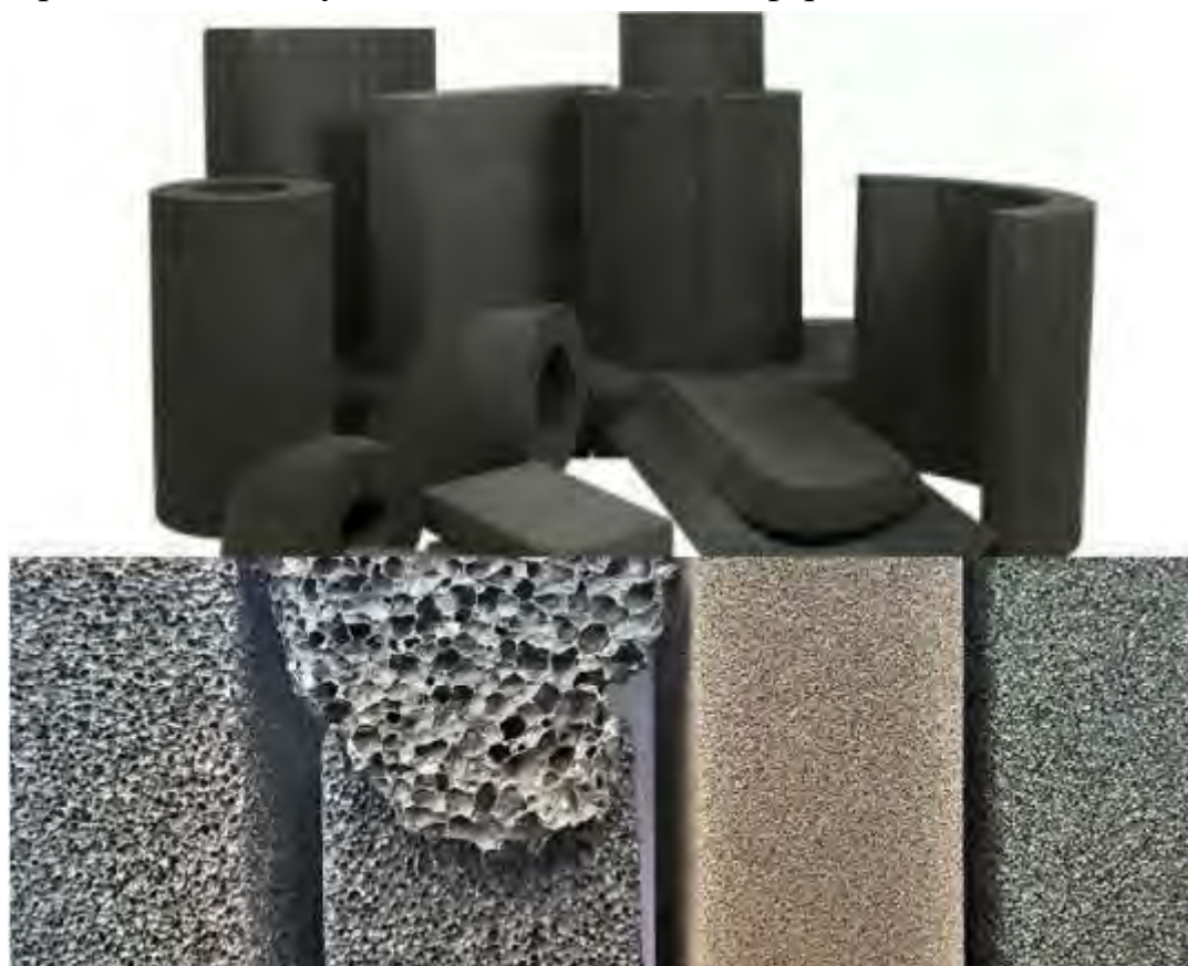
Рисунок 17.6. Разновидности структуры и изделий из пеностекла
