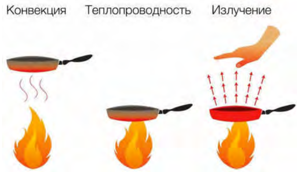
Рис. 17.1. Способы передачи тепла
