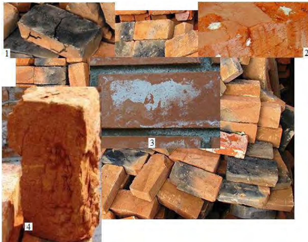
Рис. 5.7. Виды брака кирпича: 1 – пережог, 2 – известковые включения, 3 – высолы, 4 – недожог
