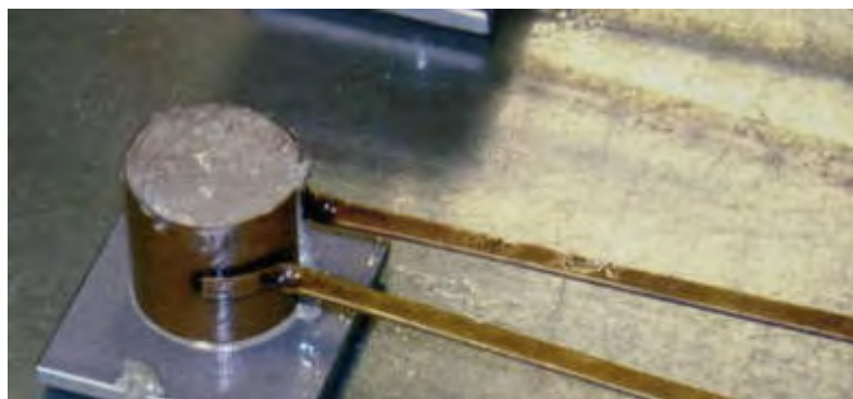
Рис. 9.8. Кольцо Ле Шателье, заполненное цементным тестом
