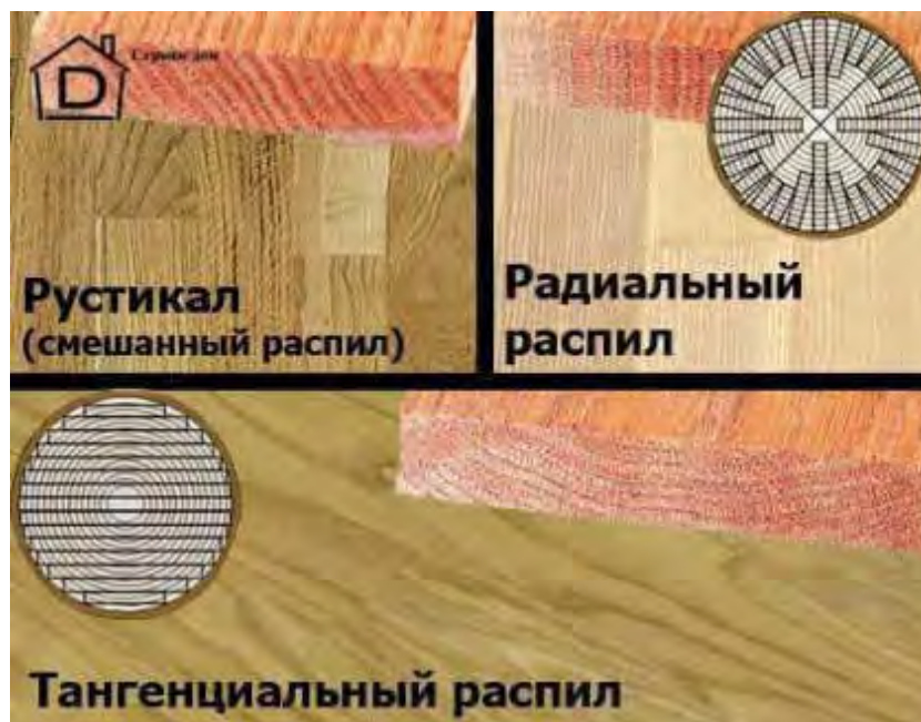
Рис.4.44. Текстура паркета в зависимости от типа распила: 1 – радиальный, 2 – тангенциальный, 3 – смешанный (рустик)
