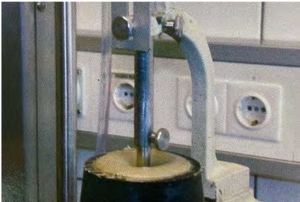
Рис. 9.7. Погружение пестика прибора Вика в цементное тесто
