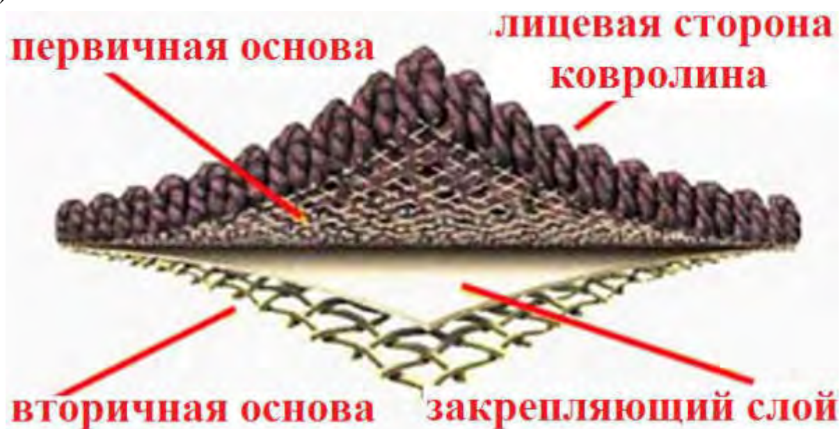
Рис. 16.9. Структура коврового покрытия
