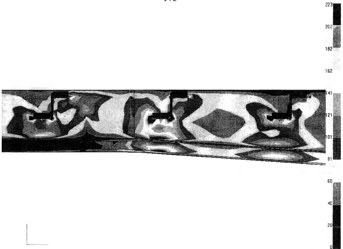
Рис. 6. Эквивалентные напряжения в передней части серийной рамы (вверху – изгиб, внизу - кручение)
