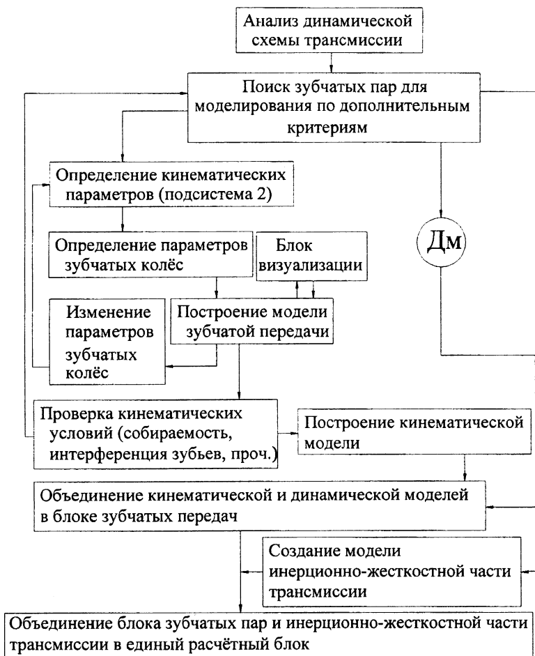
Рис. 4. Взаимосвязь кинематической и динамической моделей в едином расчетном блоке модели трансмиссии.
