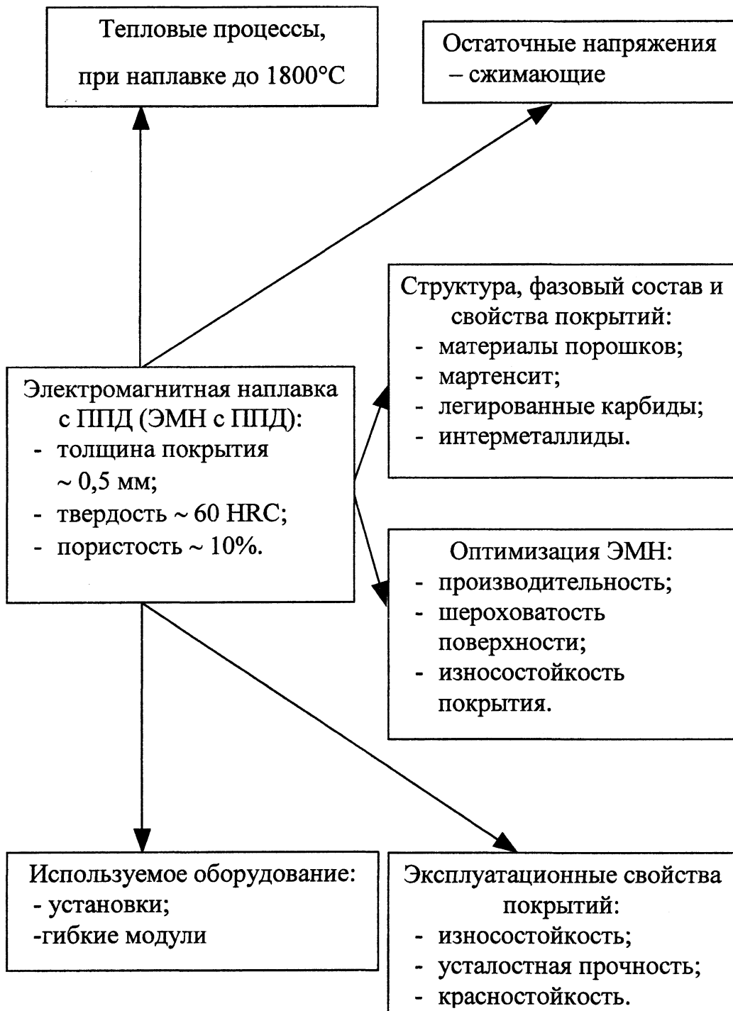
Рис. 3. Структура метода электромагнитной наплавки с ППД
