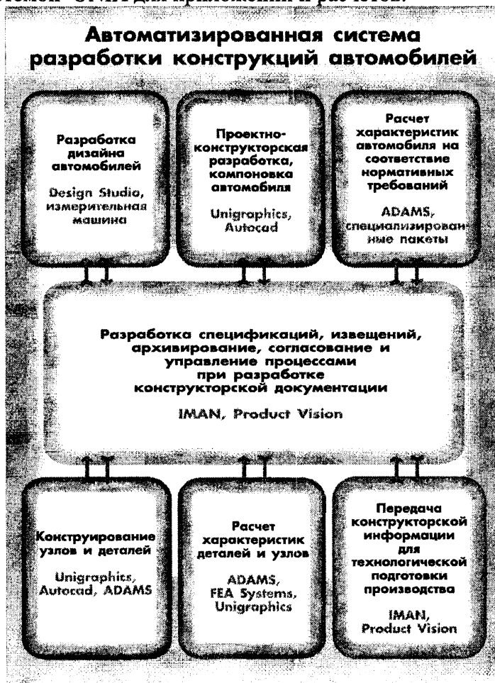
Рис. 1. Идеология автоматизированной системы разработки конструкций автомобилей и используемые программные продукты
