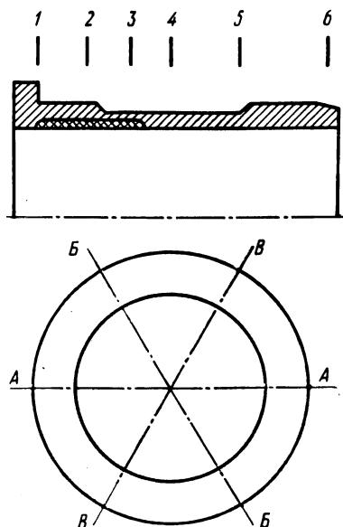
Рис. 1. Выбор сечений для измерения геометрической точности обработанных гильз.
