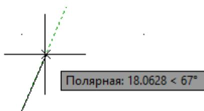
Рисунок 2.14 – Построение линии под углом  $67^0$
