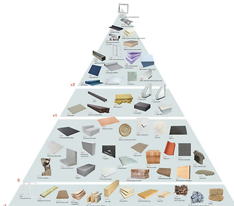
Рис. 1. Пирамида строительных материалов в зависимости от уровня выбросов CO 2 при их производстве либо утилизации (разработка датского научного проекта CINARK) [1]
