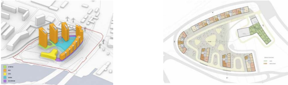
Рис. 3. Функциональное зонирование. Выбор типа секции исходя из условий инсоляции зданий
