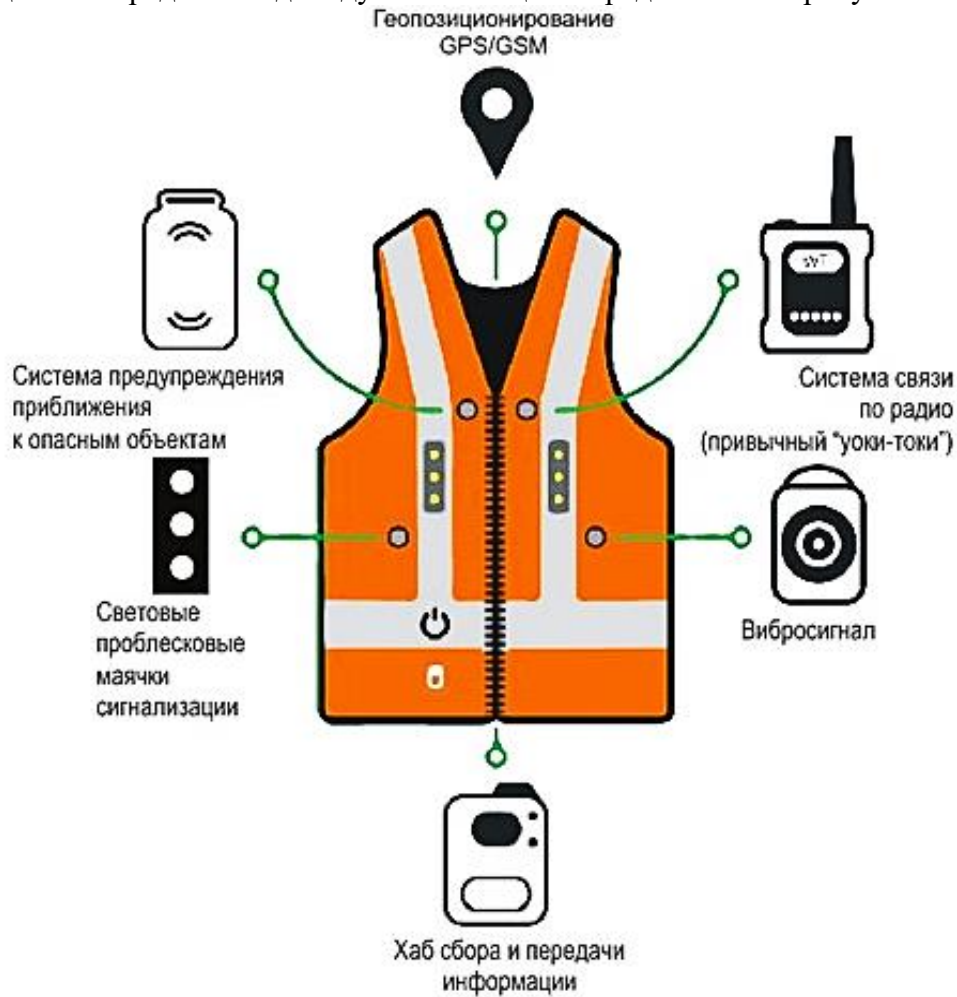
Рисунок 1.2 – Внешний вид «умного» жилета
