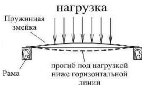
Рисунок 3 - Схема нагружения пружины "Змейка"
