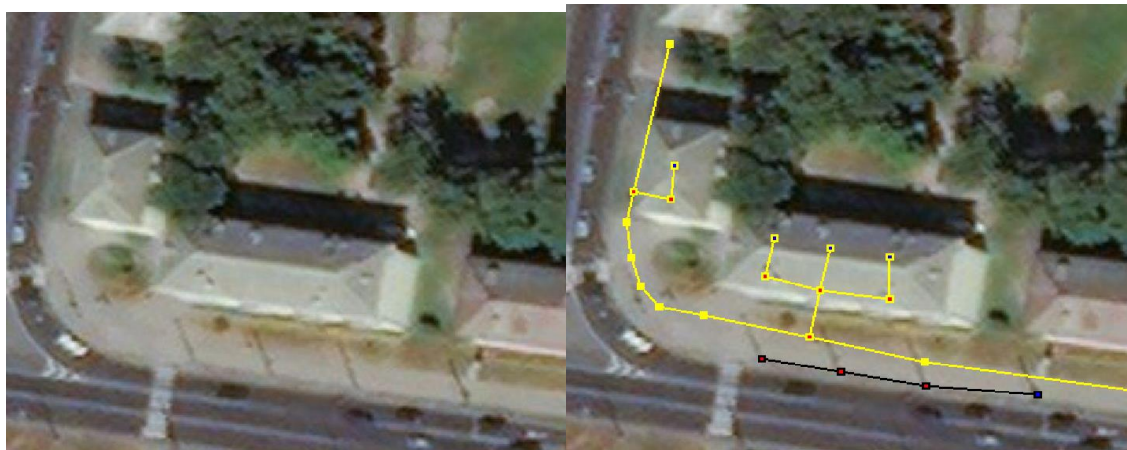
Рисунок 2. – Исходный спутниковый снимок (а) и с нанесенными линиями коммуникации (б)
