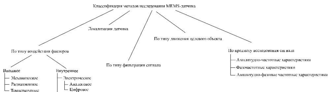
Рисунок 1. Схема классификаций методов исследования MEMS-датчиков
