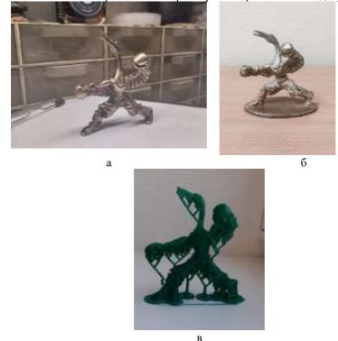
а - образец статуэтки из бронзы, б – образец статуэтки из пластика, в - образец статуэтки из PLA-пластика, изготовленного на 3D-принтере с поддержками
