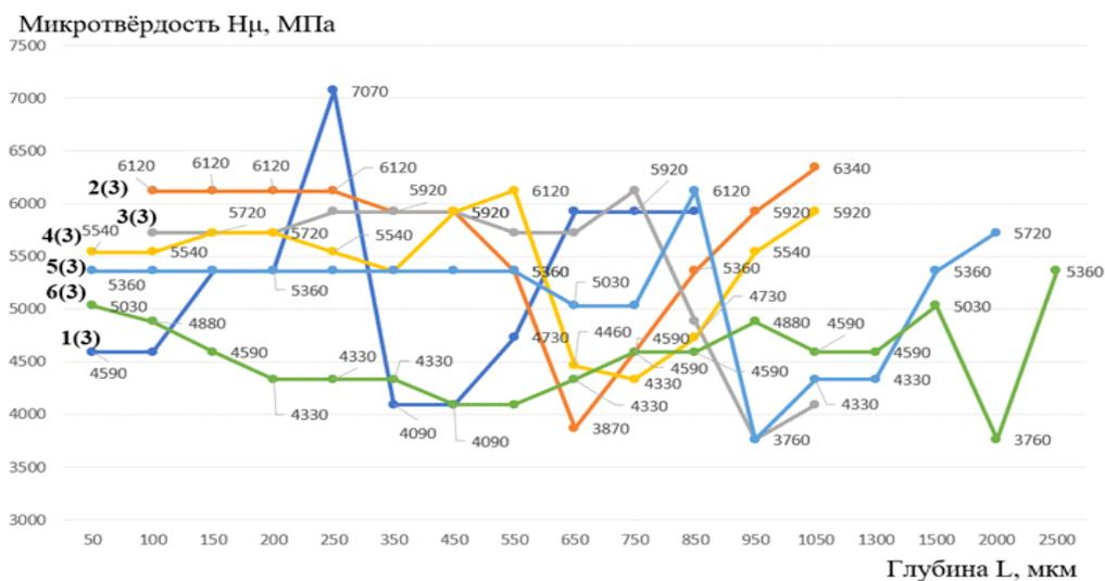
Рисунок 3 – Микротвердость образца без легирования
