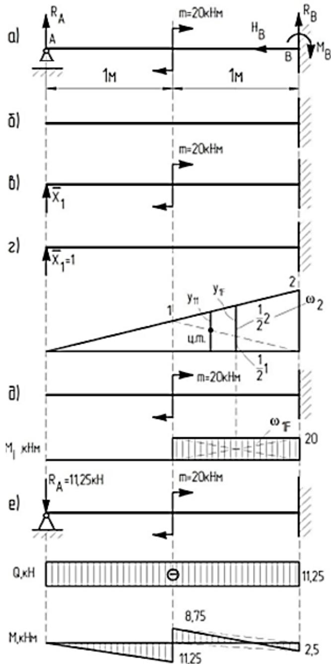
Рисунок 1. – Статически неопределимая балка
