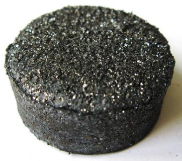
Рисунок 1 – Внешний вид брикета после восстановительного обжига
