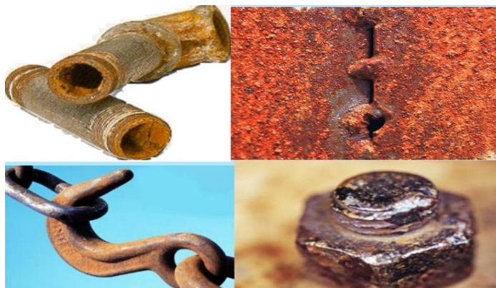
Рисунок 1 – Примеры коррозия металлов
