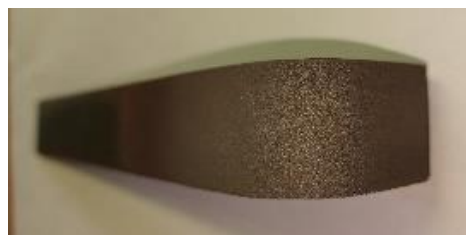
Рисунок 7 – Пластины с загибом радиусом 10 мм, напыленные порошком из хромокремниевого чугуна 20-80мкм (без трещин).
