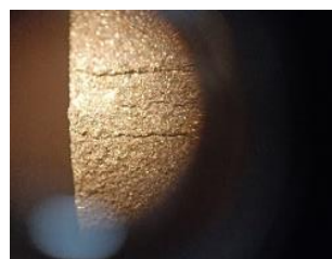
Рисунок 6 – Пластина с загибом радиусом 10 мм напыленная порошком из хромокремниевого чугуна 80-150 мкм. (трещины)
