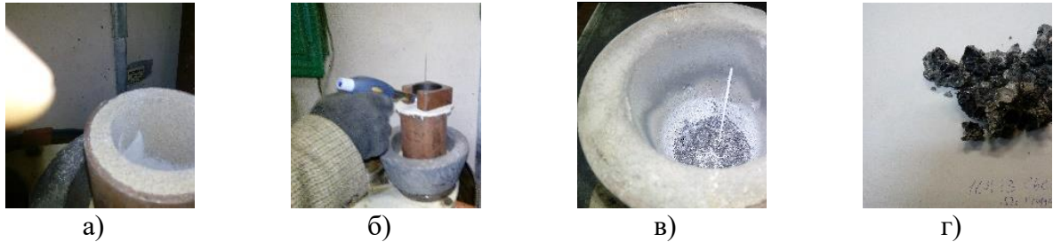
Рисунок 2 – Методика проведения и результаты восстановительной плавки олова. а – тигель с восстановительной смесью; б – начало плавки; в – окончание процесса; г – продукты плавки;
