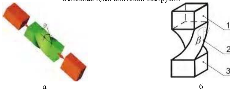
Рисунок 1 – Схема, поясняющая суть винтовой экструзии: а – схема прохождения заготовки через винтовую матрицу; б – схема канала винтовой матрицы
