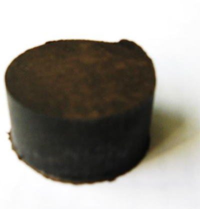
Рисунок 1 – Брикет из пылевидного отхода плавильной электродуговой печи, полученный методом холодного прессования
