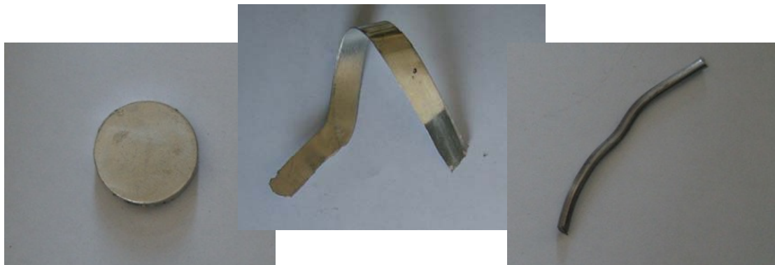
Рисунок 3 – Варианты микролиготур на основе олова с добавками ультрадисперсного порошка оксида иттрия
