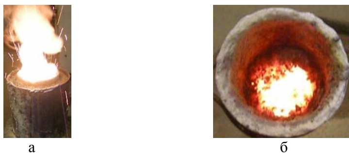
Рисунок 3 – Характер восстановительного процесса: а – в начальный период; б – после завершения реакции
