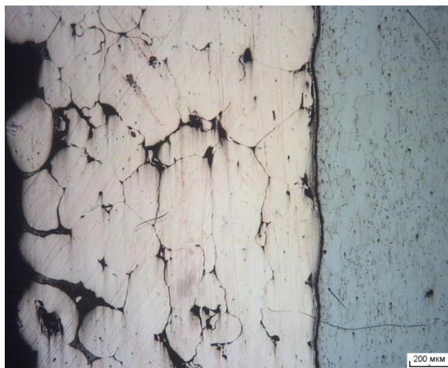
Рисунок 1 – Микроструктура двухслойного материала с неравномерной пористостью
