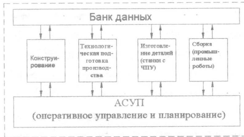
Рис. 2.1. Схема интегрированной системы проектирования и изготовления изделий
