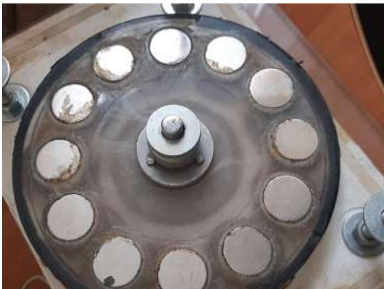
Рис. 2 – Общий вид ротора с магнитами
