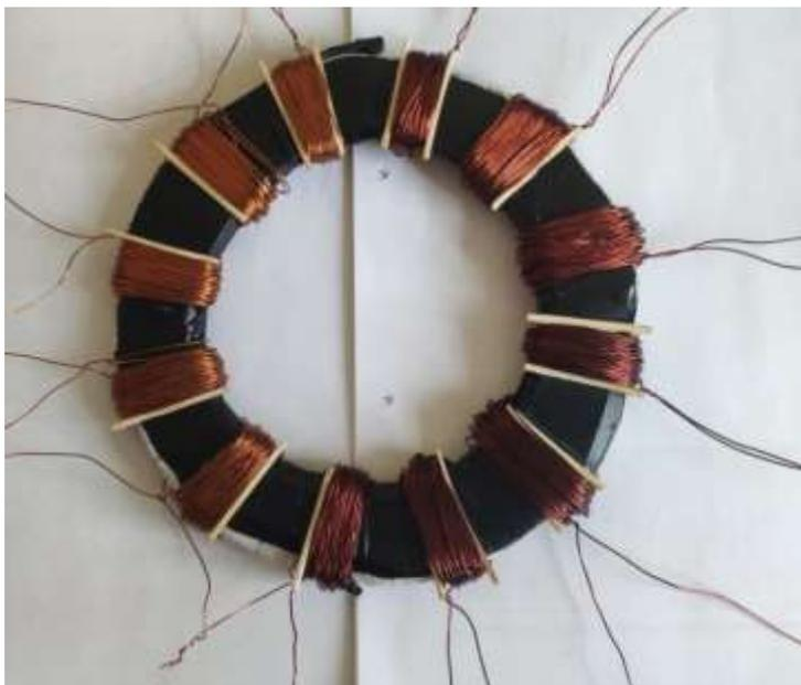
Рис. 1 – Общий вид готового статора с намотанной одной фазой из 12 катушек.
