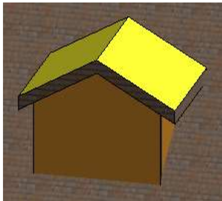
Рисунок 4.54 – Создание стен и крыши для слухового окна
