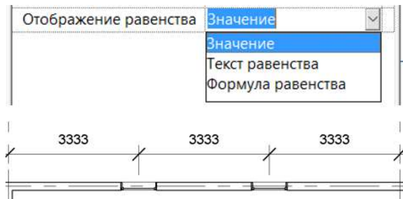
Рисунок 4.33 – Отображение значений в размере на палитре Свойства
