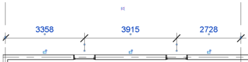
Рисунок 4.32 – Выравнивание окон с помощью размеров
