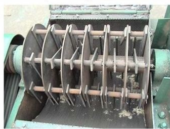
Рисунок 29 – Вид молотковой дробилки, схемы роторов, формы молотков
