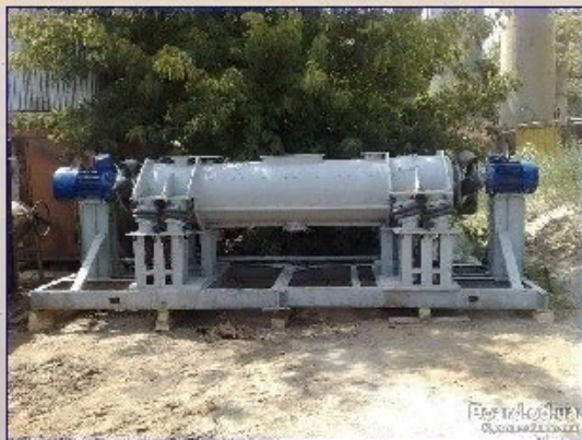
Рисунок 14 – Вибрационная мельница и ее устройство
