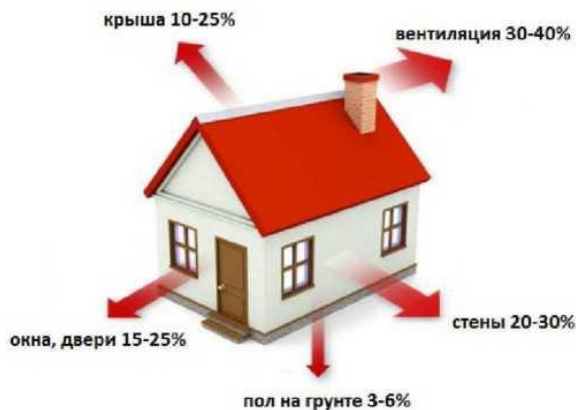
Рисунок 5.4.2. Потери теплоты через конструктивные элементы здания
