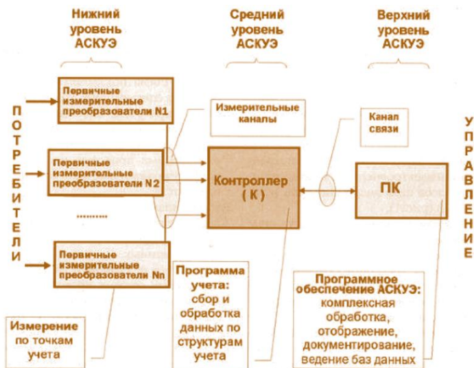
Рисунок 5.3.3. Трехуровневая схема построения АСКУЭ АСКУЭ объединяет в себе:
