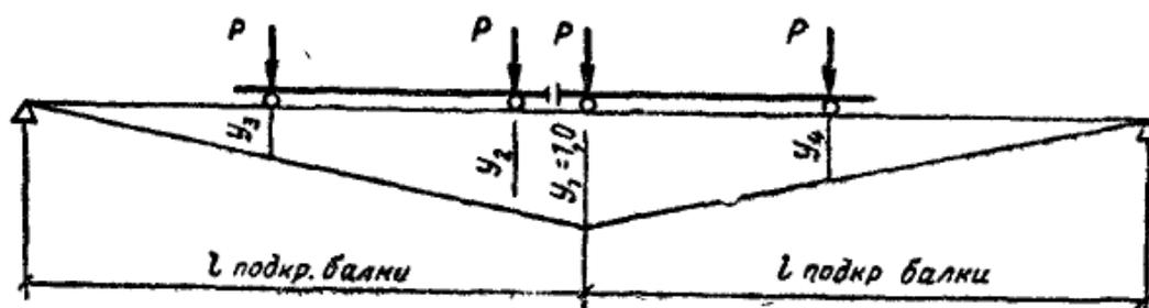
Рис.12.3. Линия влияния опорной реакции на колонну ПРЗ
