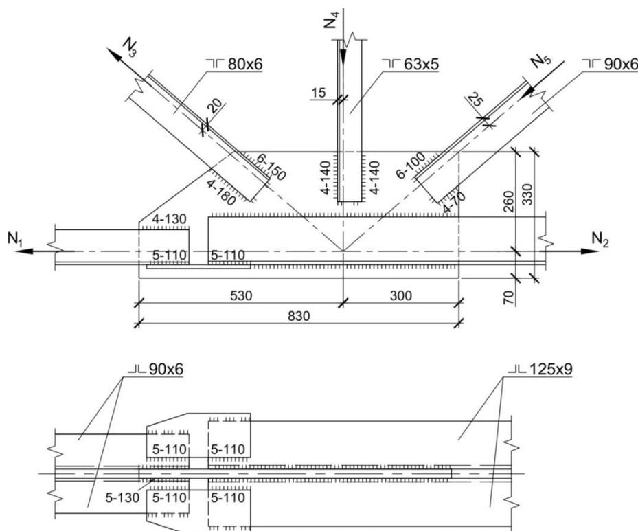
Рис. X.1. Конструкция узла фермы
