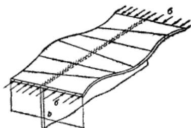
Рис. 8.8а Потеря местной устойчивости сжатого пояса балки.
