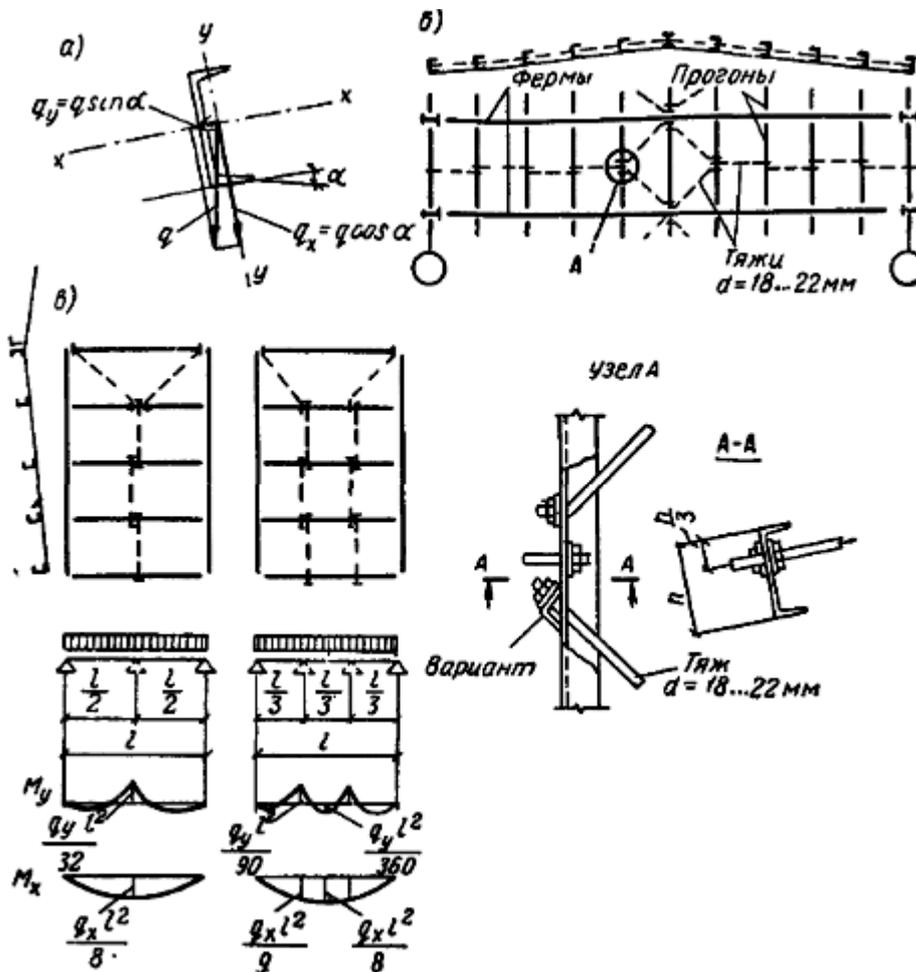
Рис. 13.3. К расчету прогонов
