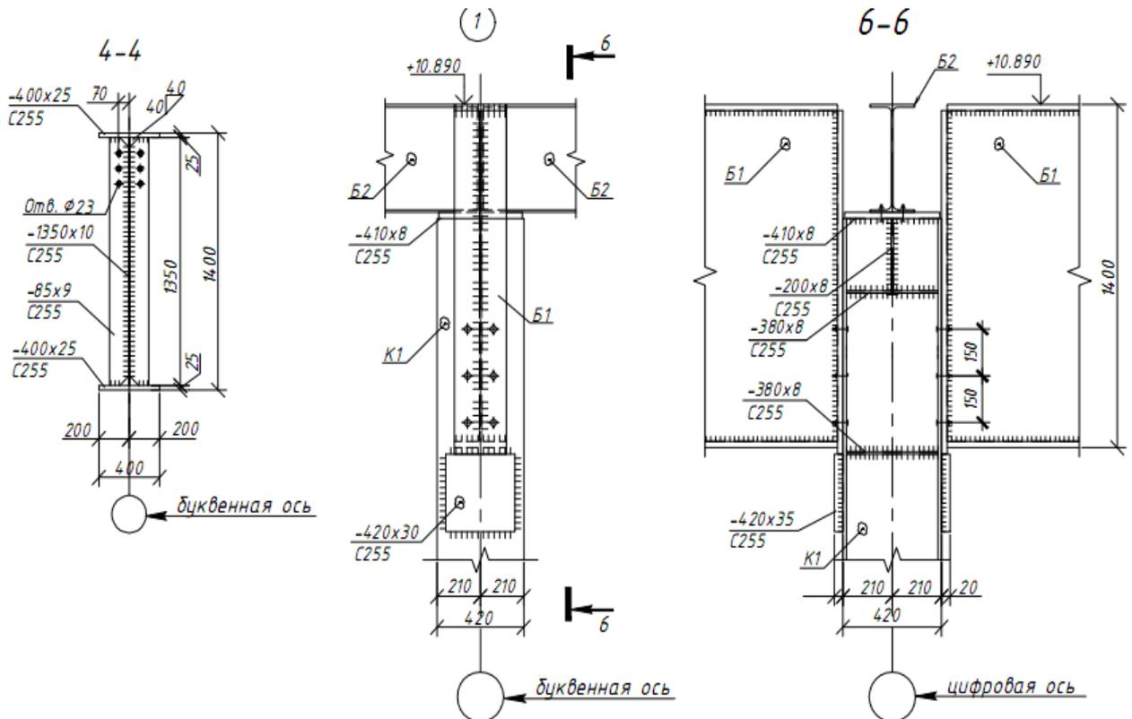
Вариант опирания балок настила Б2 сверху на колонну К1, балки Б1 сбоку; 4-4- приведено как решается конструкция ребер жесткости ГБ.
