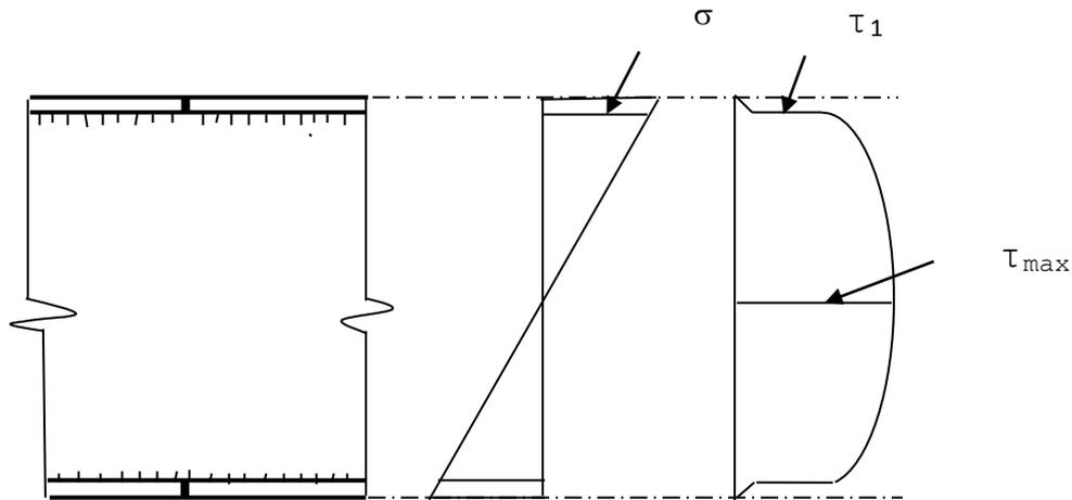
Рисунок 8.8. Напряженное состояние стенки.
