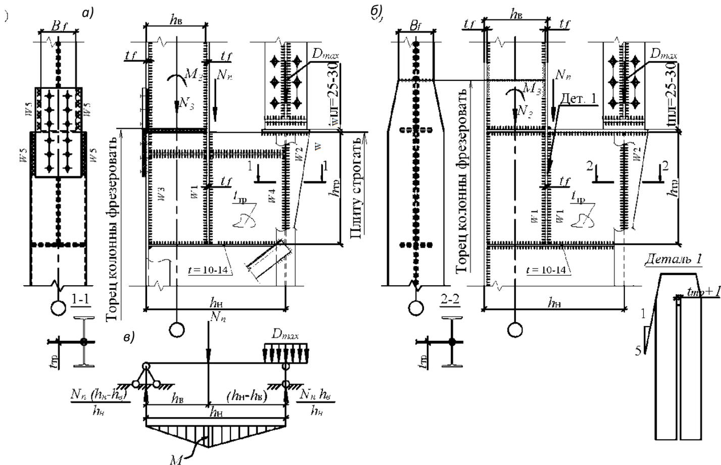
Рис. 14.9. Узлы сопряжений верхней и нижней частей колонн:
