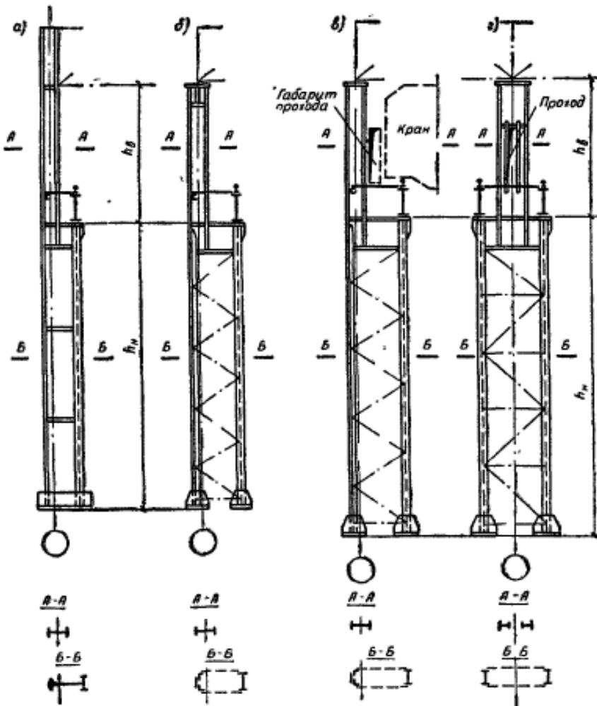
Рис. 14.2. Ступенчатые колонны производственных зданий
