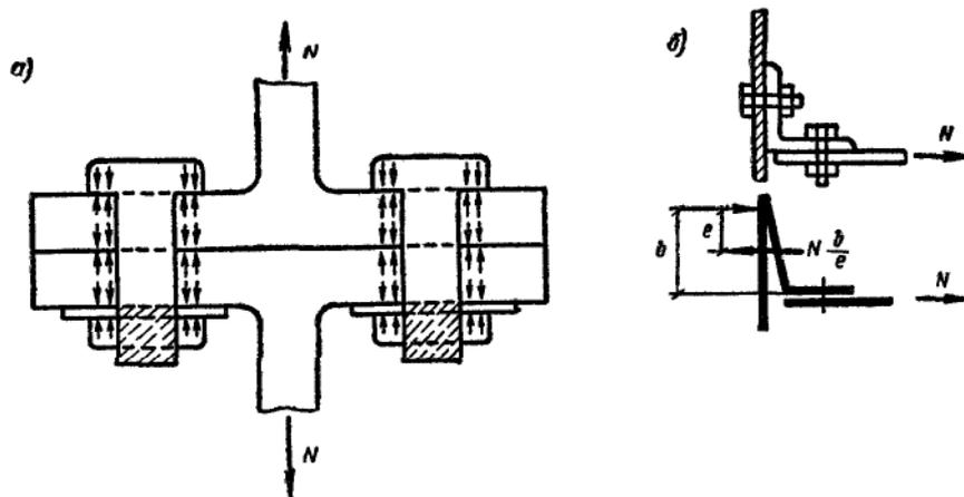
Рис. 5.7. Работа болтов на растяжение
