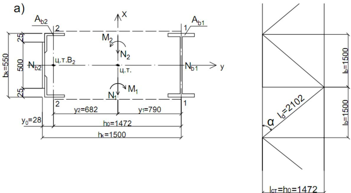
Рис. XIV.4. К примеру расчета сквозной колонны:
