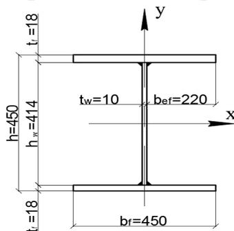
Рис. IX. 2 Сечение сплошной колонны
