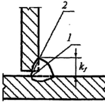
Рис. 5.7 Схема расчетных сечений сварного соединения с угловыми швами: 1 – по металлу шва; 2 – по металлу границы сплавления.
