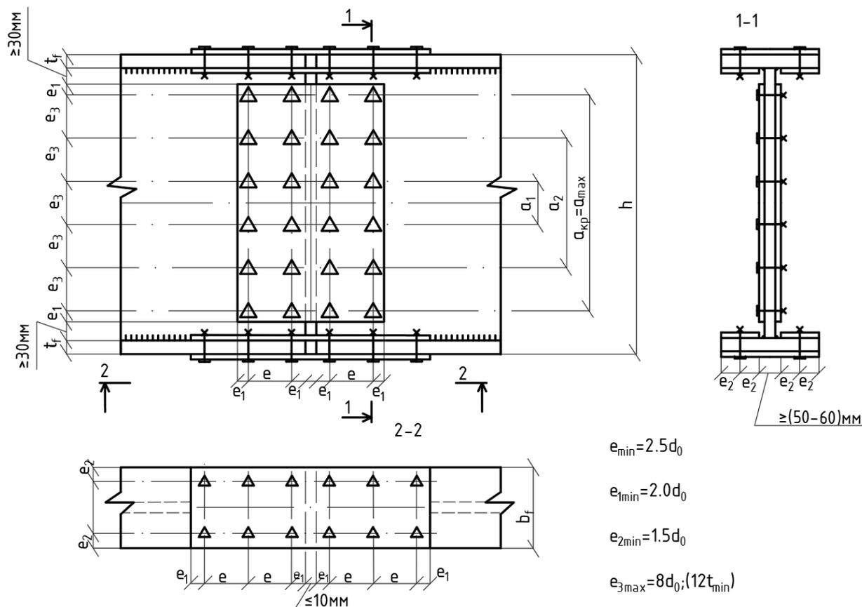
Рис. 8.15. Монтажный стык составных балок на высокопрочных болтах.
