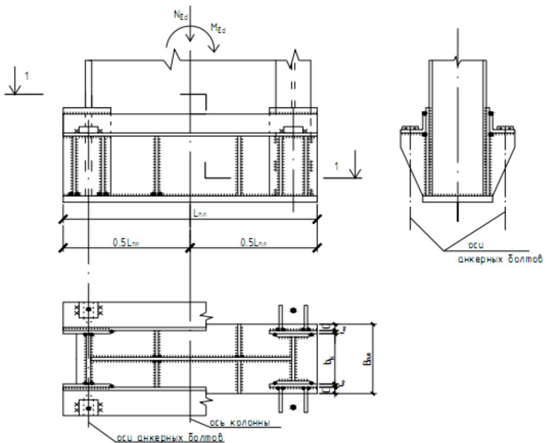
Рис. 14.13.1. База ступенчатой колонны сплошного типа
