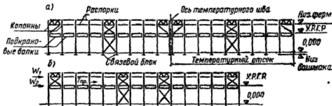
Рис. 11.7. Расположение связей между колоннами
