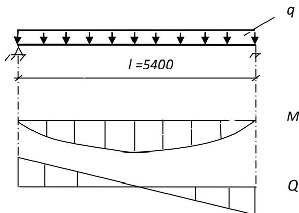
Рис. VIII.1 Расчетная схема балки.
