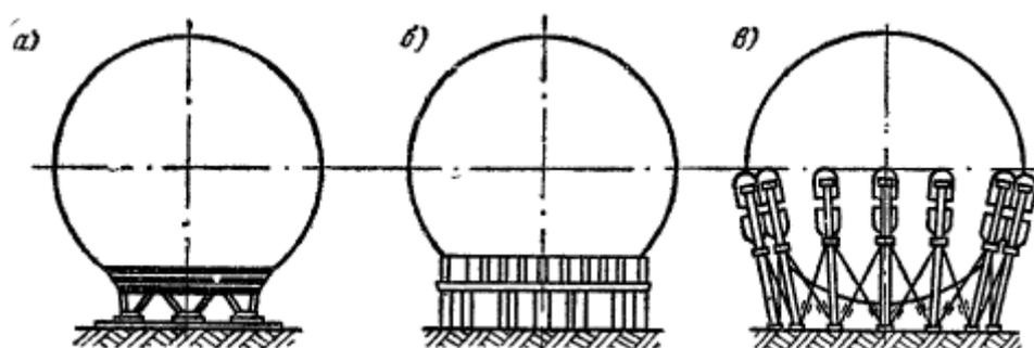
Рис.17.11. Шаровые резервуары
