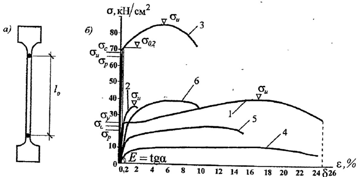
Рис. 2.3. Работа стандартного образца стали при растяжении: *а* – образец для испытаний; *б* – диаграммы растяжения: 1 – малоуглеродистой стали; 2 - чугуна; 3 – высокопрочной легированной стали 12ГН2МФАЮ; 4 – алюминия; 5 – алюминиевого сплава АМгг2; 6 - алюминиевого сплава 1915Т.
