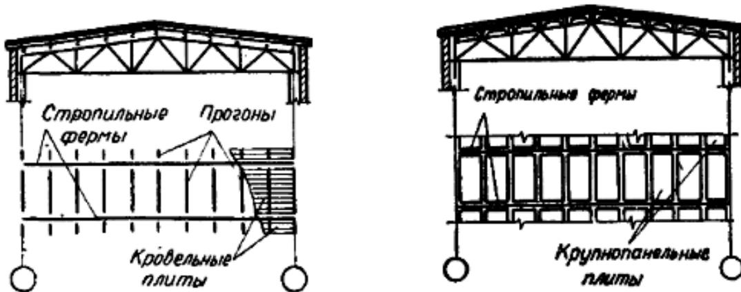
Рис. 13.1. Схема прогонного и беспрогонного покрытия
