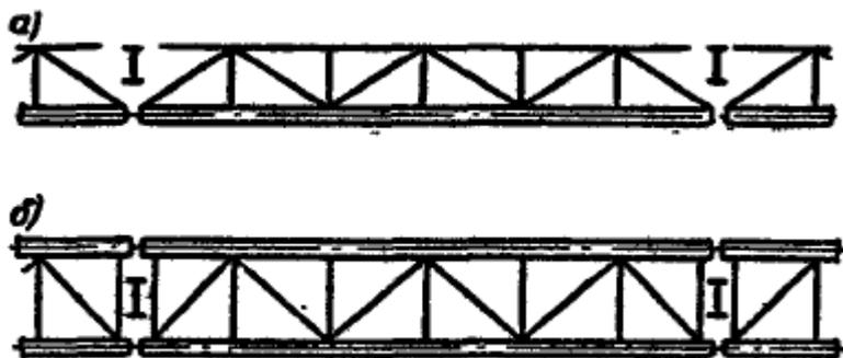
Рис. 16.4. Сквозная тормозная конструкция
