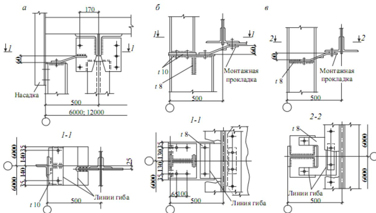
Рис.15.2 Примыкание стоек фахверка к конструкциям покрытия:
