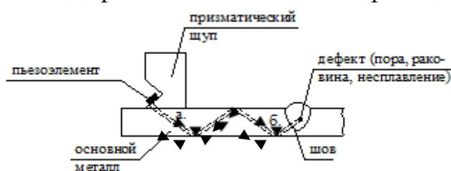
Рис. 6.3. Схема обнаружения дефектов с помощью ультразвука
