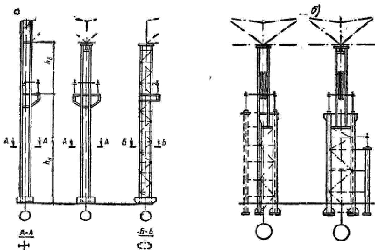
Рис. 14.1 Колонны производственных зданий
