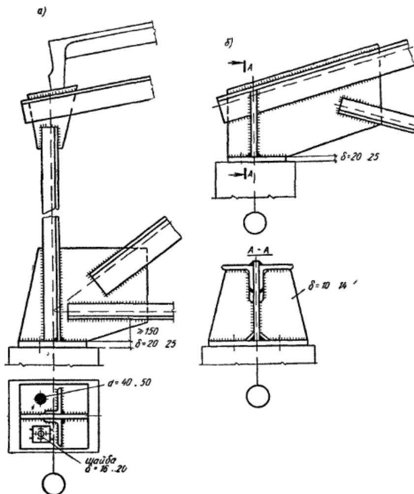
Рис. 13.8. 1. Опорный узел фермы на опору сверху.
