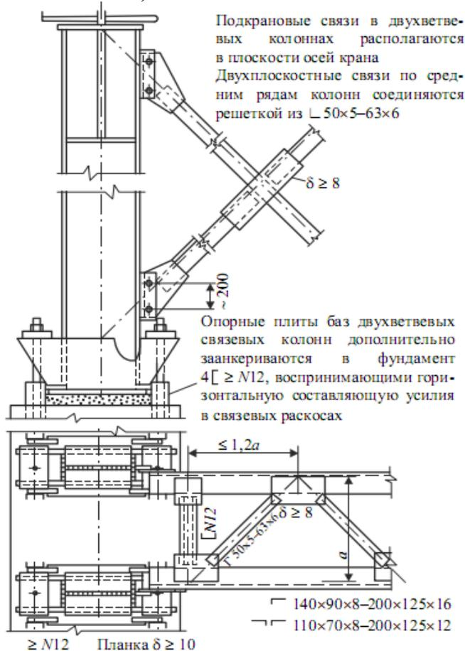
Рис. 11.9а. Пример двухплоскостных связей между колоннами при высоте сечения колонны  $h_n > 600$ мм
