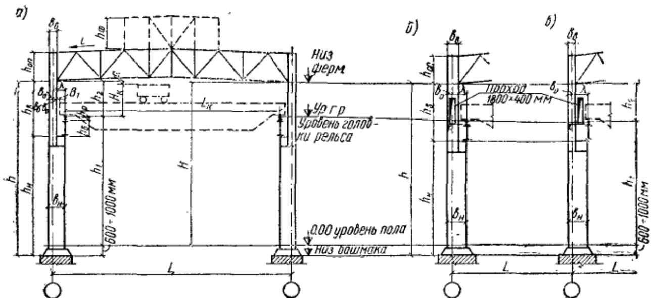
Рис.11.6. Компоновка поперечных рам
