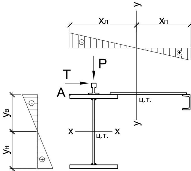
Рис. 16.7. К расчету подкрановой балки
