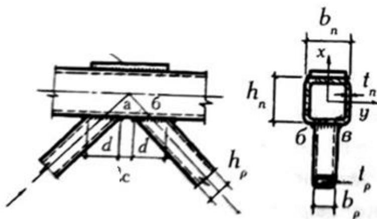
Рис. 10.13. К определению размеров стержней ферм из ГСП.
