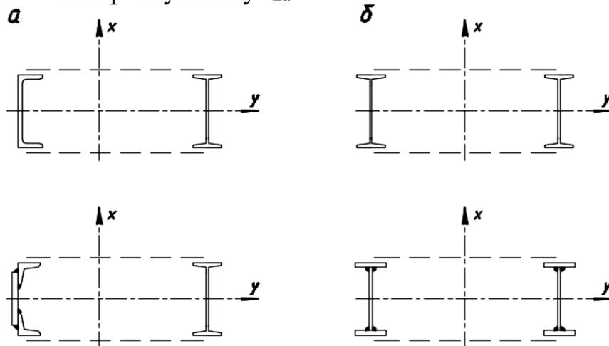
Рис. 14.7. Типы сечений сквозных колонн:
