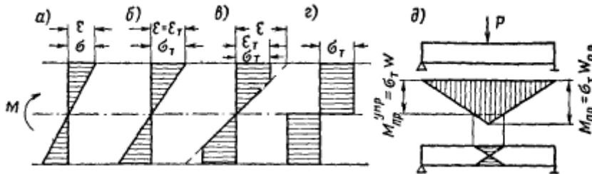
Рис.3.1 Эпюры нормальных напряжений при изгибе
