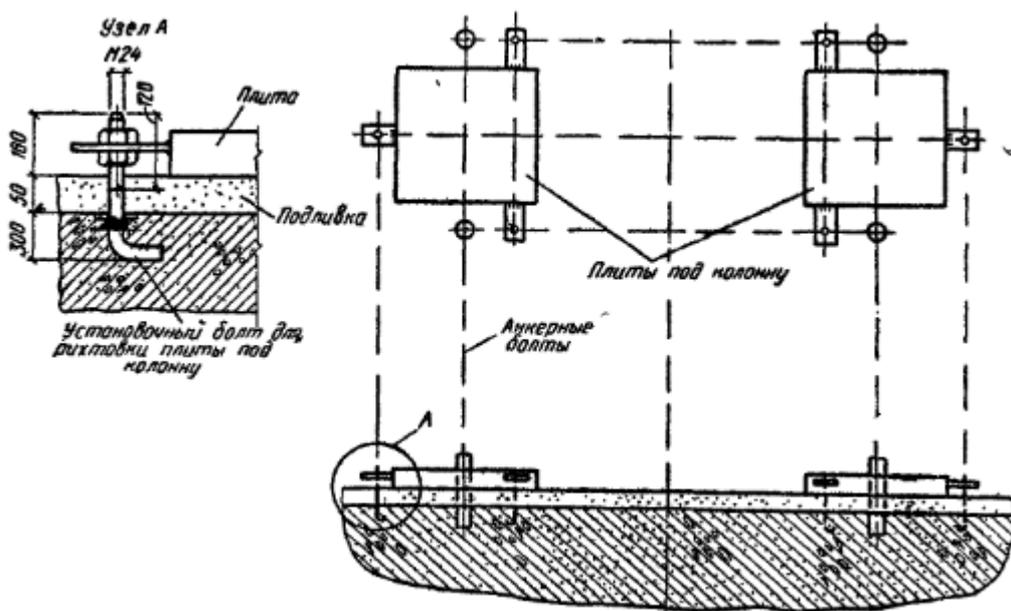
Рис. 14.10.1. Опорные плиты баз для колонн с фрезерованным торцом.
