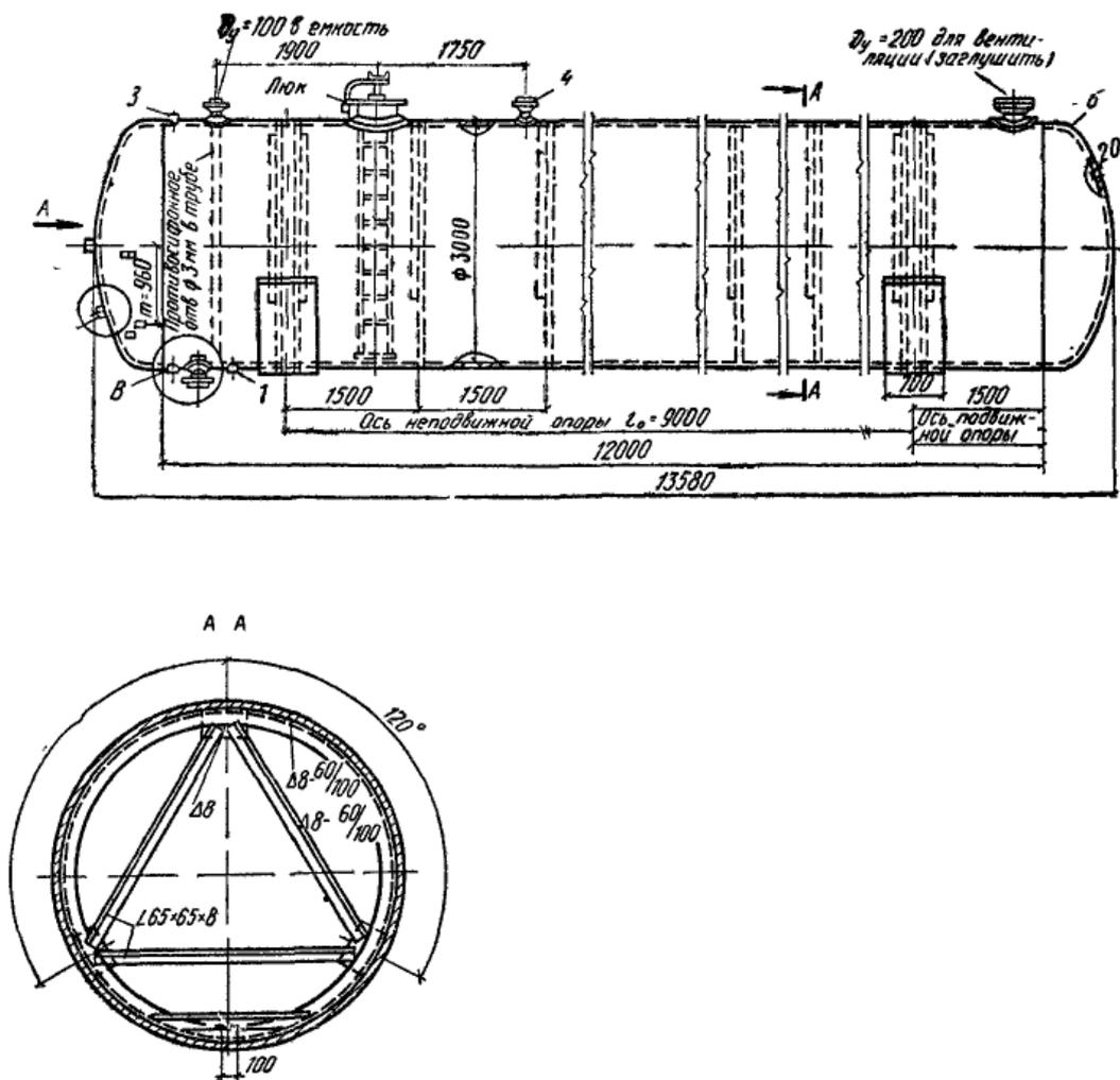
Рис. 17.9. Горизонтальный цилиндрический резервуар вместимостью 100 м<sup>3</sup>: разрез А-А – диафрагма жесткости
