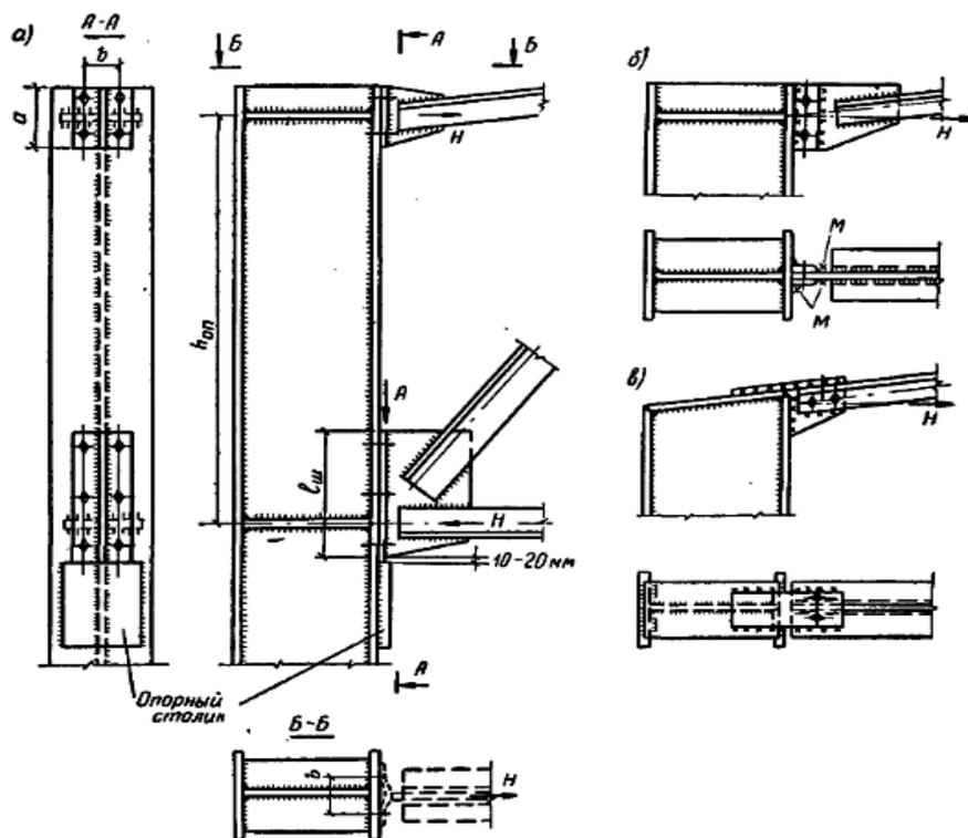
Рис.13.8. Узлы опирания стропильной фермы на колонну сбоку
