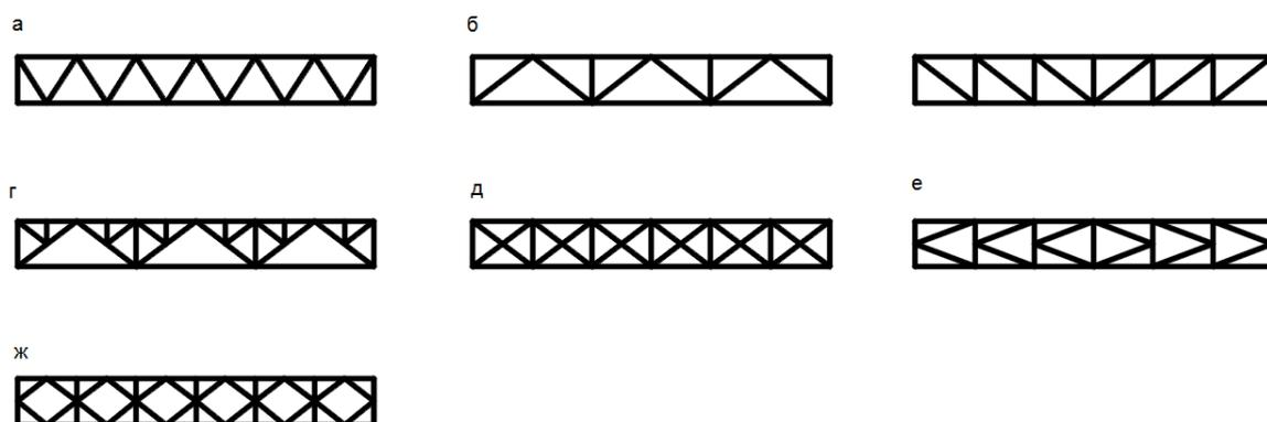
Рис. 10.3. Типы решёток ферм: а- треугольная; б- треугольная со стойками; в- раскосная; г- шпренгельная; д- крестообразная; е- полукасосная; ж- ромбическая.
