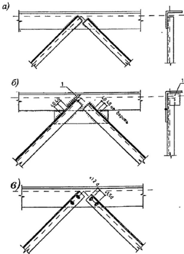
Рис. 10.15. Узлы ферм из одиночных уголков. 1- планка в опорном раскосе.
