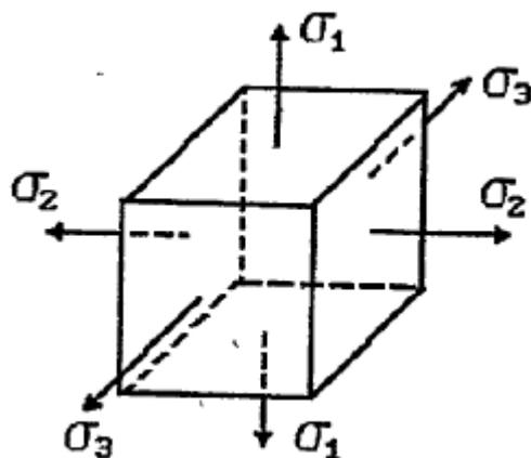
Рис. 2.4 Сложное напряженное состояние
