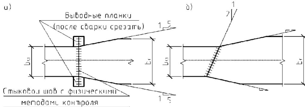
Рисунок 8.7. Конструкция стыка нижнего пояса (растянутого): а) – с прямым швом при применении физических методов контроля (с выводом концов шва на выводные планки); б) – с косым равнопрочным швом.
