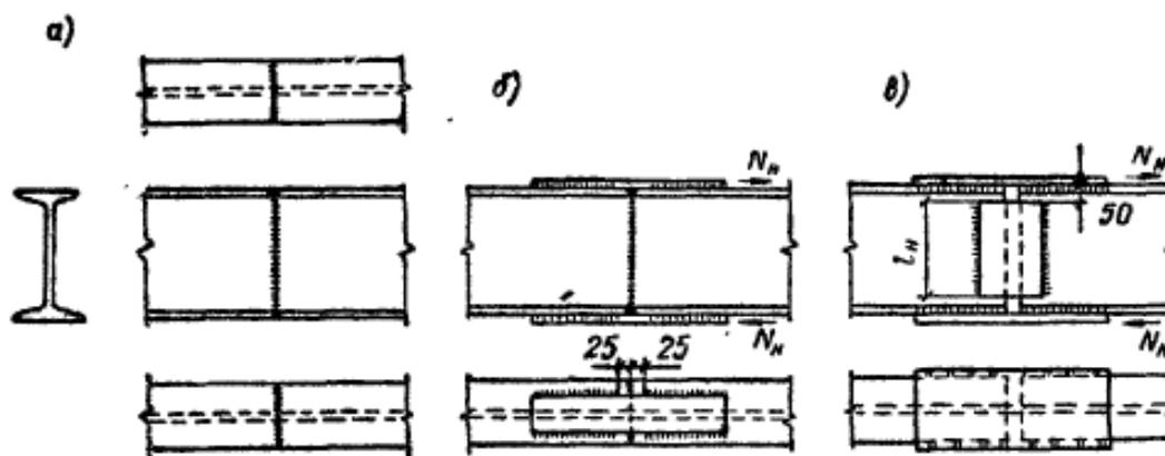
Рис. 8.14.1. Стыки прокатных балок
