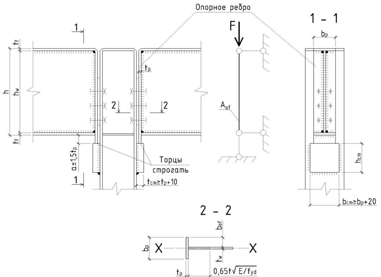
Рис. VIII.4. К расчету опорного узла.
