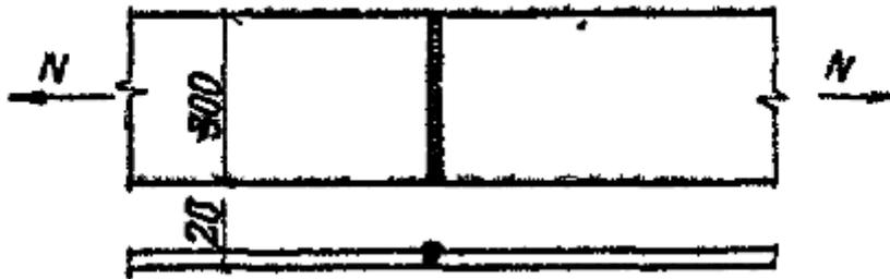
Рис. V.1 Соединение стыковым швом.
