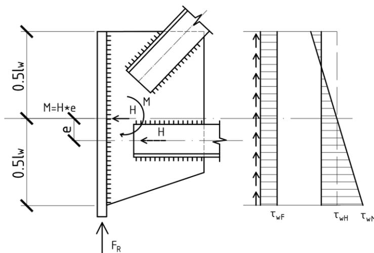
Рис.13.9. К расчету шва прикрепления фланца к фасонке
