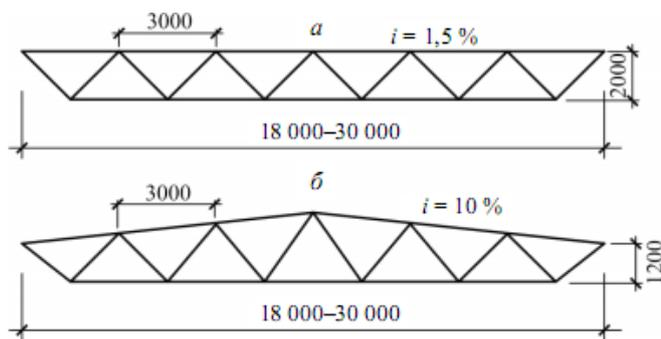
Они экономичны по расходу материала (примерно на 15-25% легче ферм из парных уголков), обладают высокой коррозионной стойкостью, просты в изготовлении, в сравнении с фермами из круглых труб, из-за прямого реза торцов элементов решетки.
