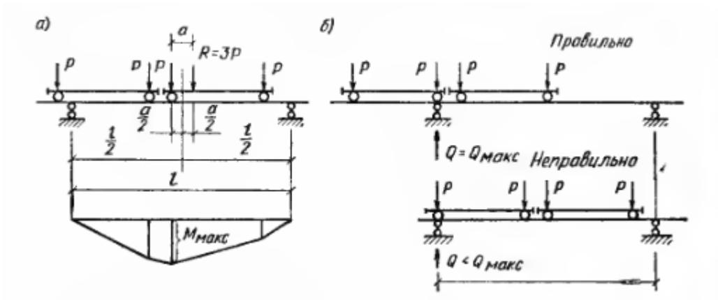
Рис. 16.6. К определению расчетных усилий в разрезной подкрановой балке а) - наибольший изгибающий момент; б) – наибольшая поперечная сила. ( на рис.  $Q$  заменить на  $V$ )
