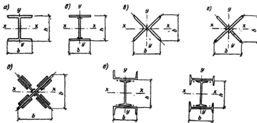
Рис. 9.3 Открытые сечения сплошных стержней
