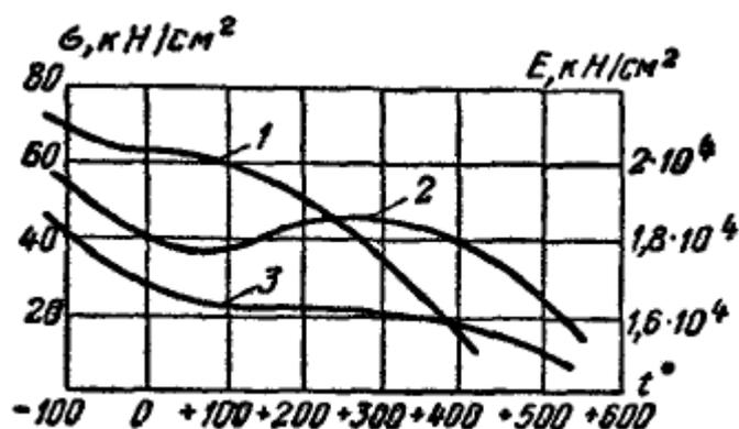
Рис. 2.10. Механические характеристики малоуглеродистой стали при изменении температуры: 1 – модуль упругости; 2 – предел прочности  $f_{uk}$  (временное сопротивление); 3 – предел текучести  $f_{yk}$ .
