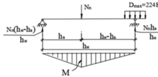
Рис. XIV.5. Конструкция сопряжения верхней части колонны с нижней, расчетная схема траверсы
