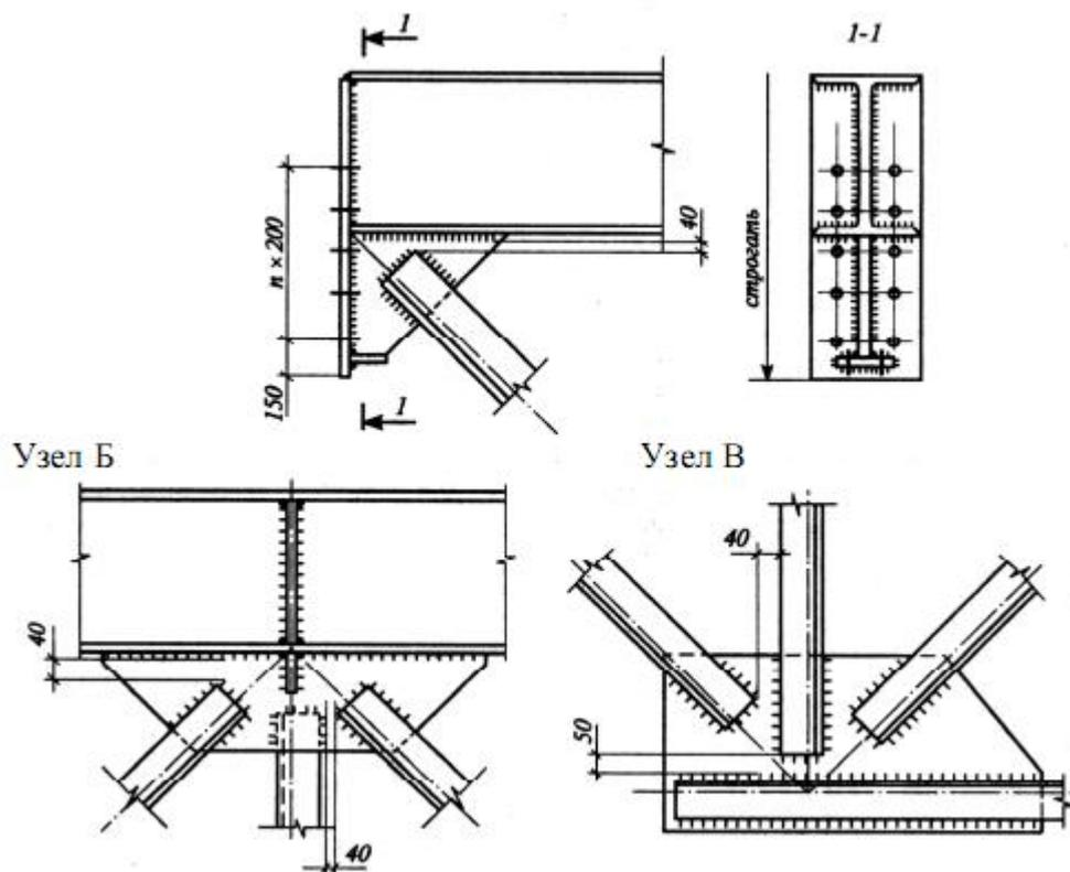
Рис. 16.10 Сварные узлы подкрановых ферм.
