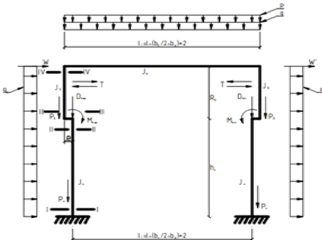
Рис. 12.2. Расчетная схема однопролетной рамы с приложенными нагрузками
