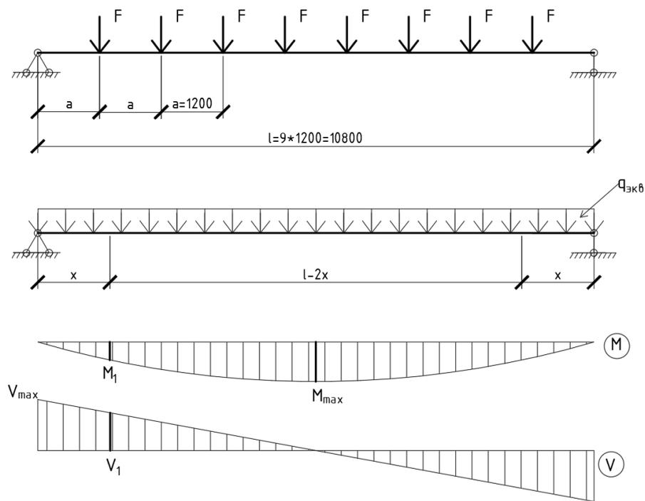
Рис. VIII.2 Расчетная схема главной балки
