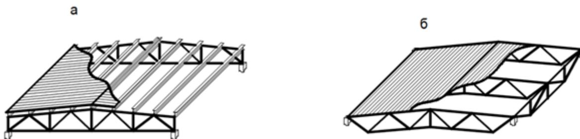
Рис. 11.4. Конструктивные варианты покрытий со стальным профилированным листом: а- прогонное покрытие; б- беспрогонное покрытие;
