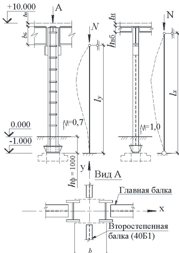
Рис. IX. 3 К определению расчетной длины сквозной колонны
