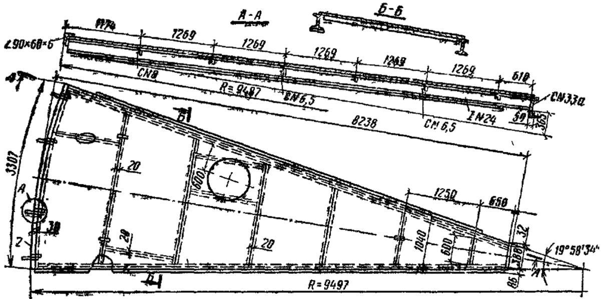
Рис. 17.7. Щит кровли вертикального цилиндрического резервуара вместимостью  $3000\text{ м}^3$
