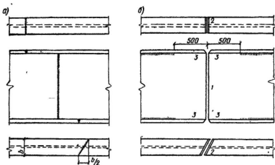
Рис. 8.14.2. Стыки составных сварных балок
