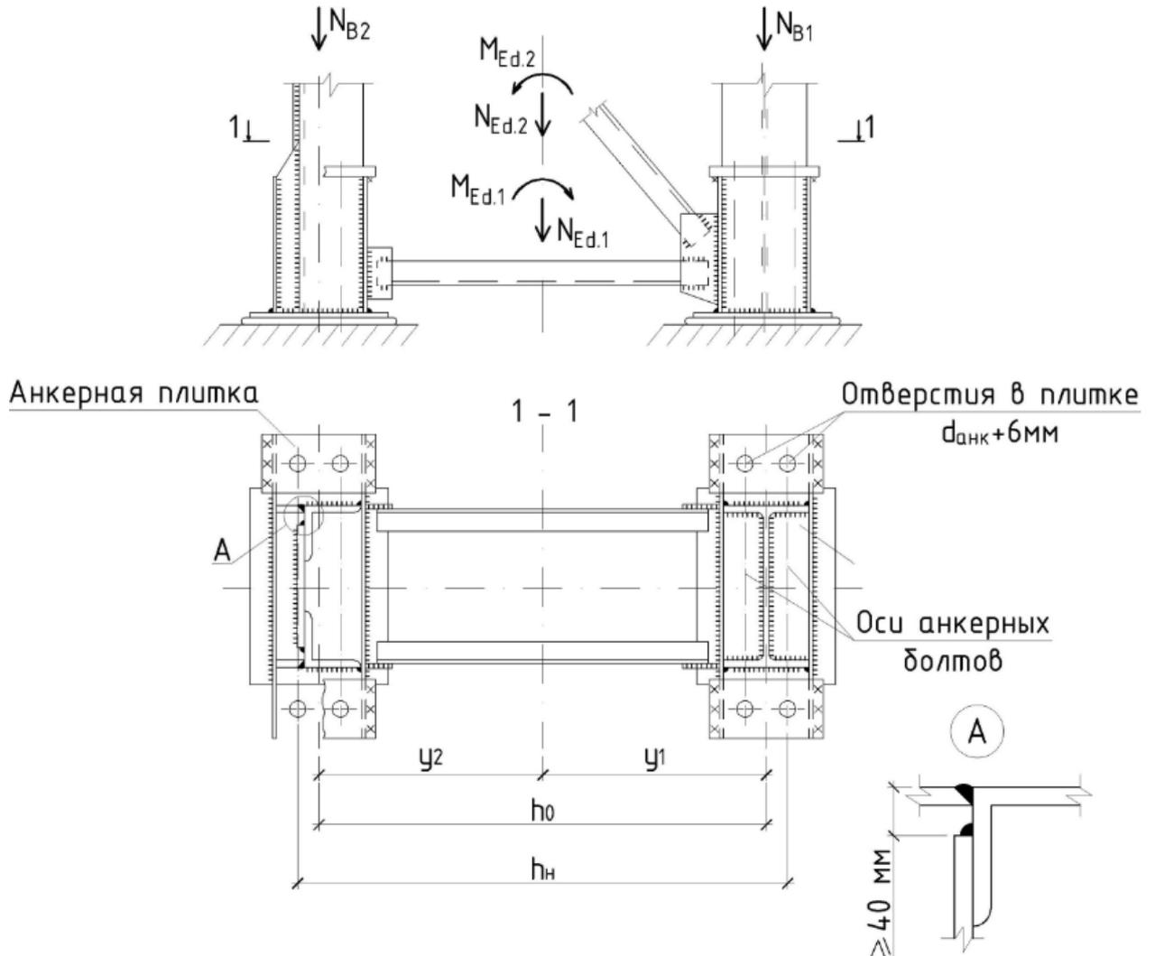
Рис. 14.12. К расчету базы внецентренно сжатой сквозной колонны
