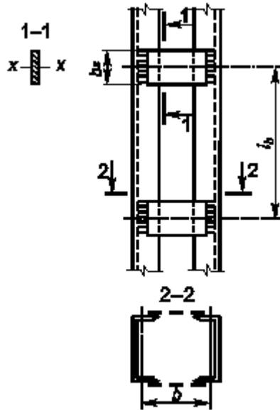
Рис. 9.7. (Продолжение рис.). Стержень колонны сквозного сечения:
