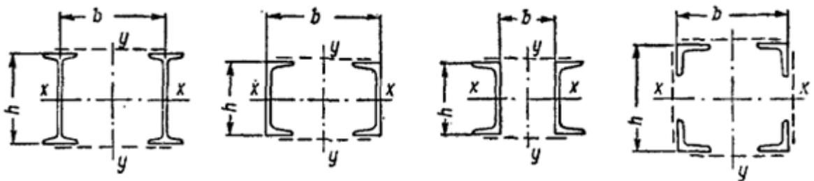
Рис. 9.6. Сечения сквозных колонн с ветвями из двутавров, швеллеров и уголков.
