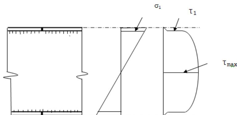
Рис. VIII.3.а. Напряженное состояние стенки в месте изменения сечения
