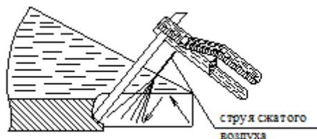
Рис. 4.2. Схема воздушно-дуговой резки
