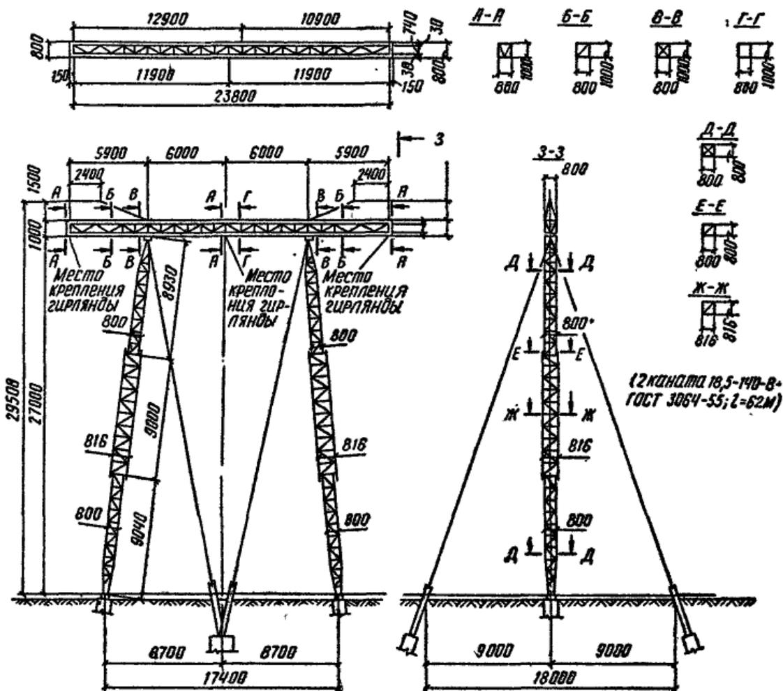
Рис. 18.4. Общий вид промежуточной порталной опоры из уголков на оттяжках линии 500 кВ (стволы стоек опоры в виде мачт)
