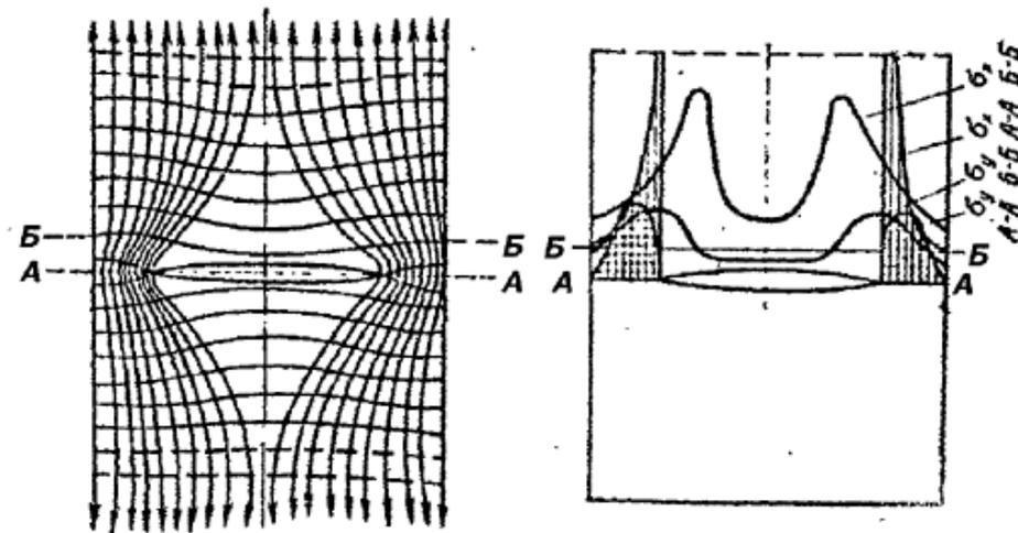
Рис. 2.6 Концентрация напряжений
