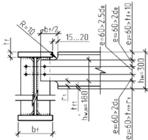
Рис. VIII.5. Сопряжение балки настила с главной.
