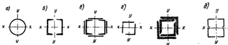
Рис. 9.4 Замкнутые сечения сплошных стержней
