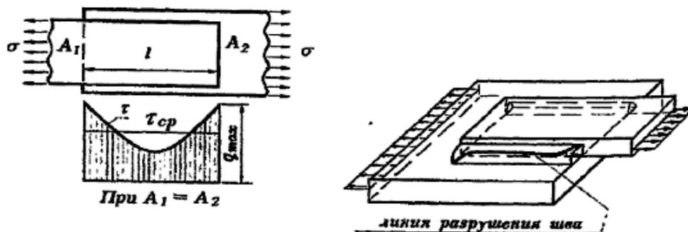
Рис.5.6 Распределение напряжений и разрушение углового флангового шва.
