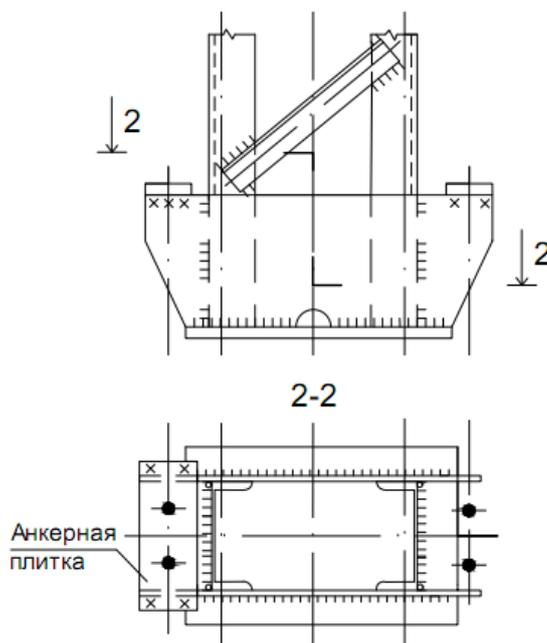
Рис. 14.12.1. Конструкция базы сквозной колонны постоянного по высоте сечения.
