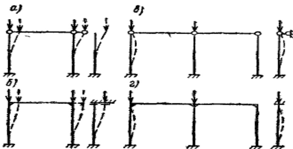
Рис. 14.3. К определению расчетных длин колонн
