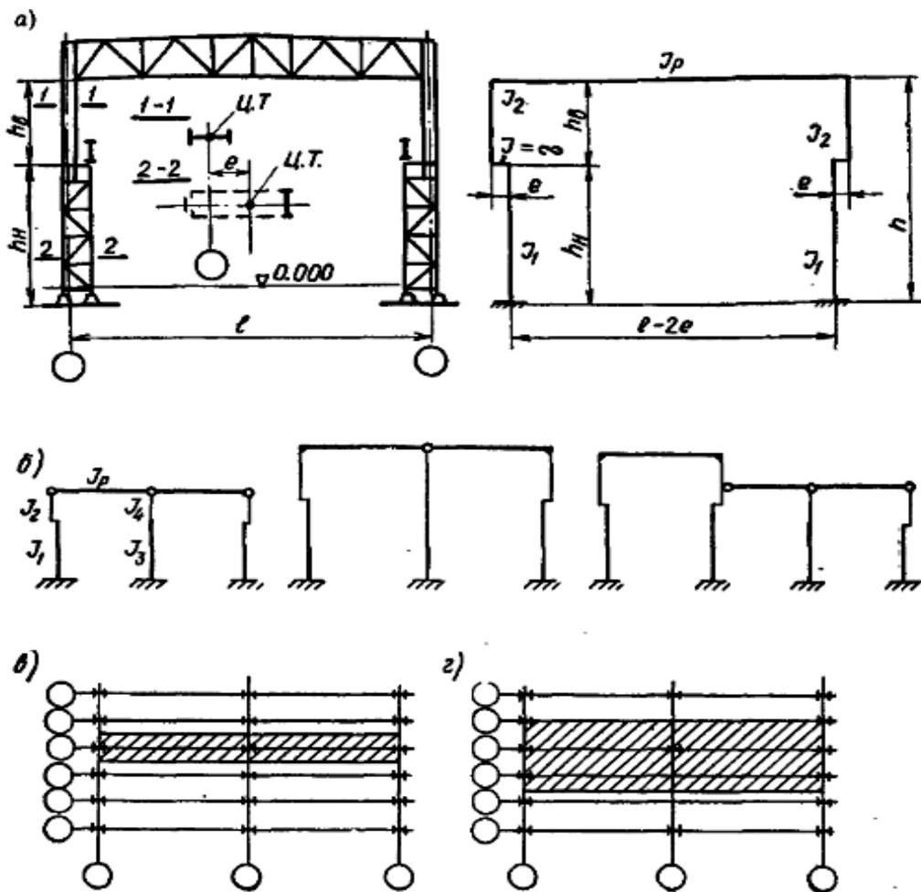
Рис.12.1 Расчетные схемы рам
