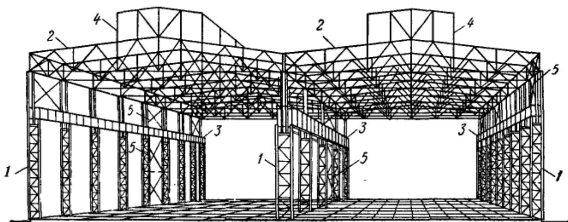
Рис. 11.1. Конструктивная схема двухпролетного промышленного здания: 1- колонны; 2- фермы; 3- подкрановые балки; 4- П-образный светоаэрационный фонарь; 5 – связи по колоннам.
