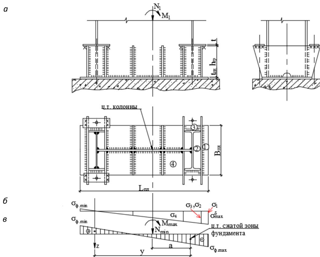
**Рис. 14.14** К расчету баз сплошных внецентренно сжатых колонн
