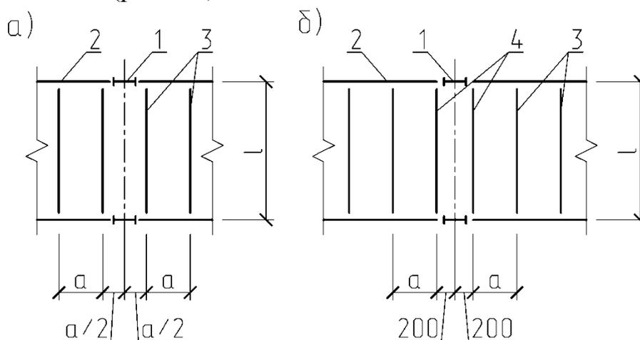
Рисунок 18.4. Размещение балок настила при установке главных балок на колонны сверху:
