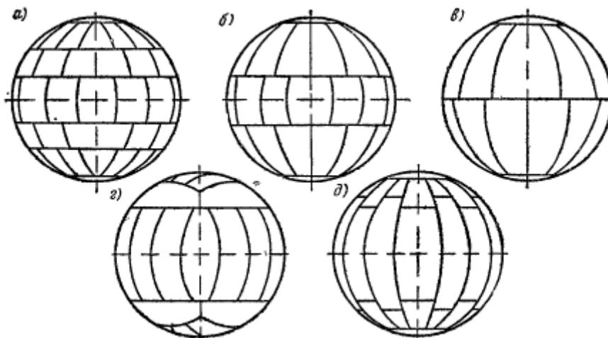
Рис. 17.12 Схемы раскроя шаровых резервуаров вместимостью  $600 \text{ м}^3$
