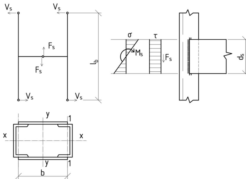
Рис.9.8 К расчету планок
