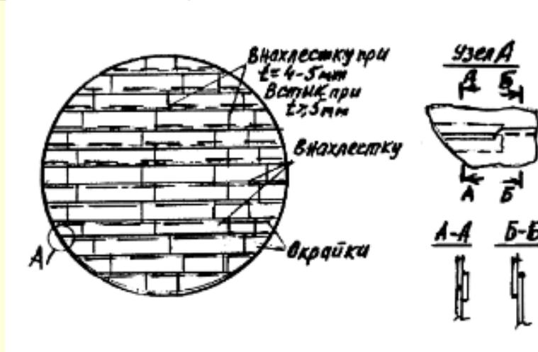
Рис.17. 5 Днище резервуара.
