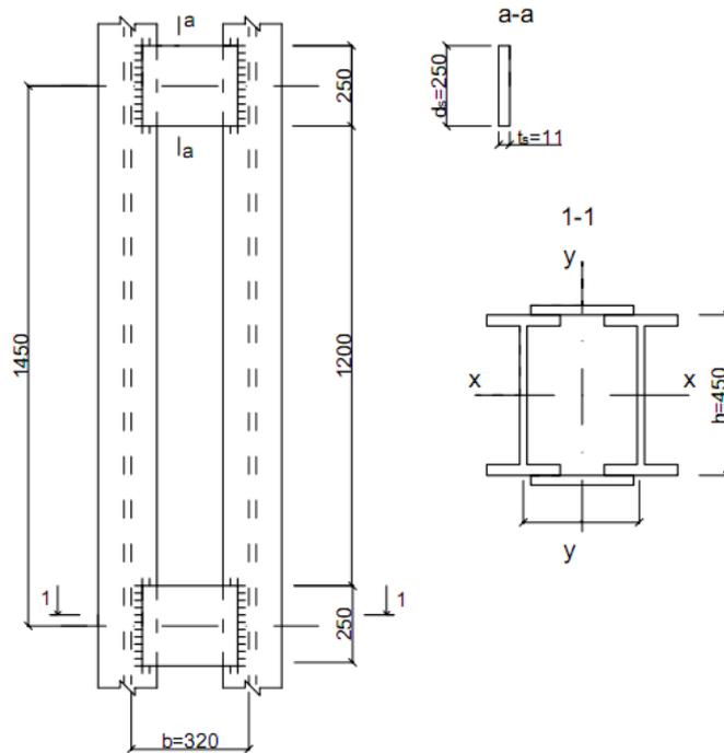
Рис. IX.5 Сечение сквозной колонны
