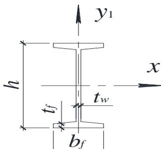
Рис. IX. 4 Сечение двутавра
