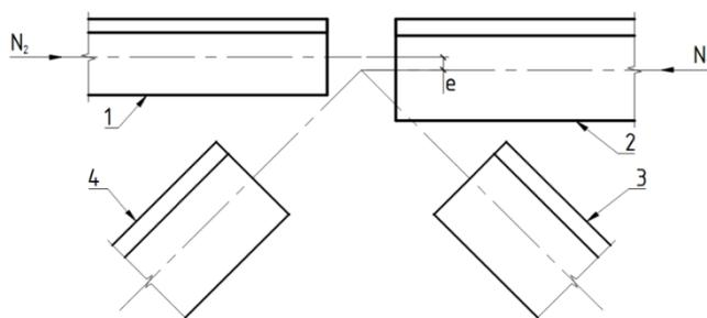
Рис. 10.5. Эксцентриситет в месте стыка поясных стержней.
