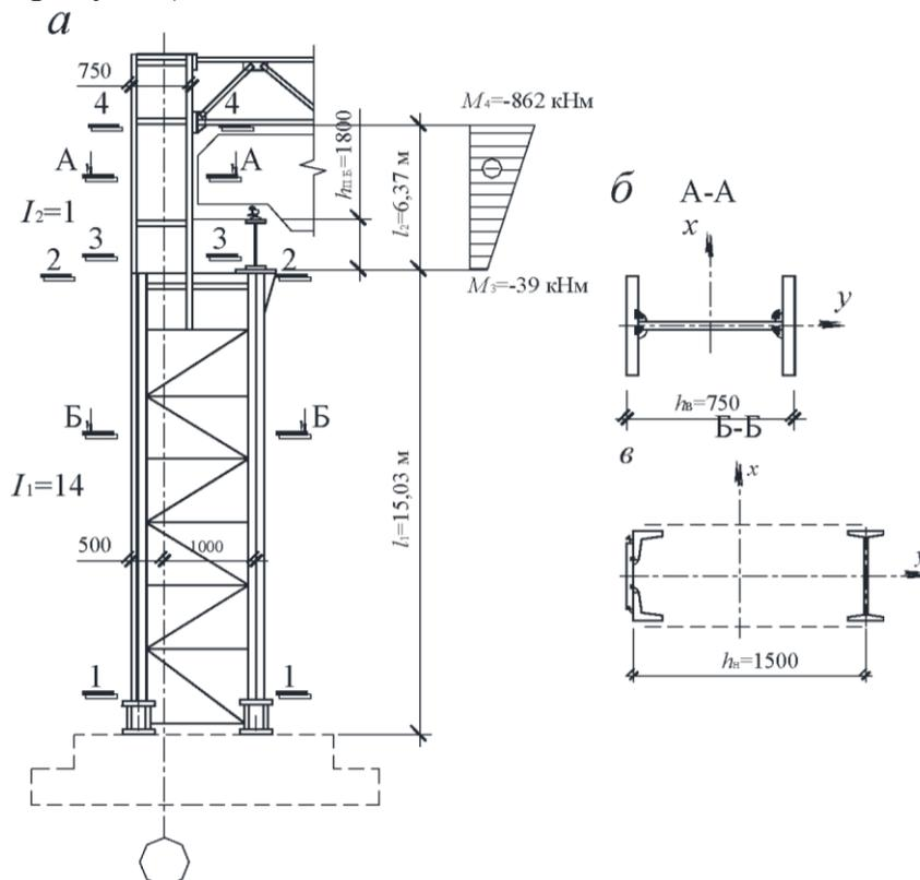
Рис. XIV.1. Конструктивная схема ступенчатой колонны
