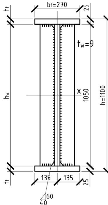
Рис. VIII.3 Сечение главной балки
