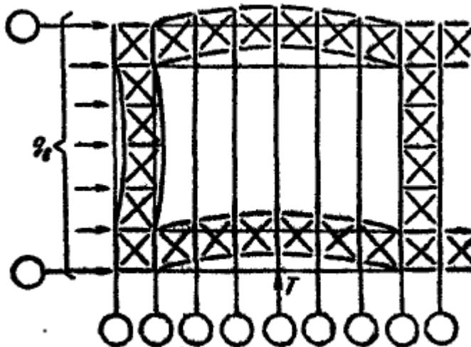
Рис. 11.11. Работа связей по нижним поясам ферм на действие крановой ( $T$ ) и ветровой нагрузок ( $q_w$ ).
