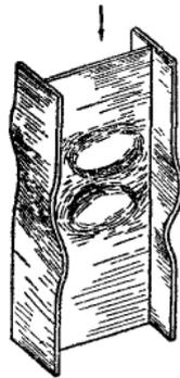
стержня в целом (см. рисунок). Местное выпучивание каким либо элементом сечения колонны (потеря местной устойчивости) и выход его из работы резко ослабляет стержень, часто делая оставшуюся часть сечения несимметричной; центр изгиба при этом перемещается, стержень начинает закручиваться и быстро теряет общую устойчивость.
