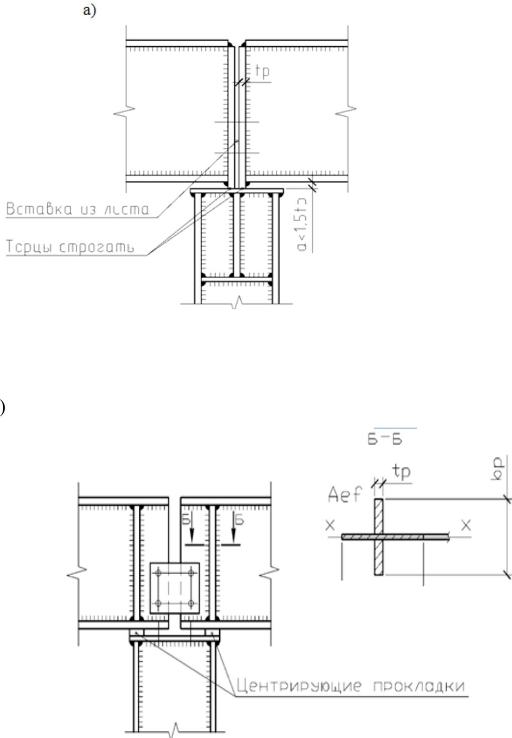
Рисунок 8.13. (начало). Опираие главных балок на колонны:
