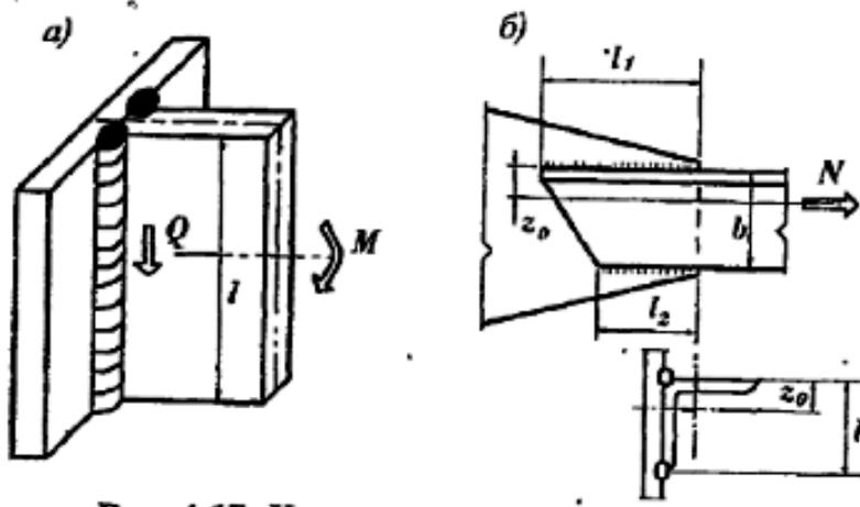
Рис. 5.8 К расчету сварных соединений с угловыми швами: а) – на момент и поперечную силу; б) – приварка уголка.
