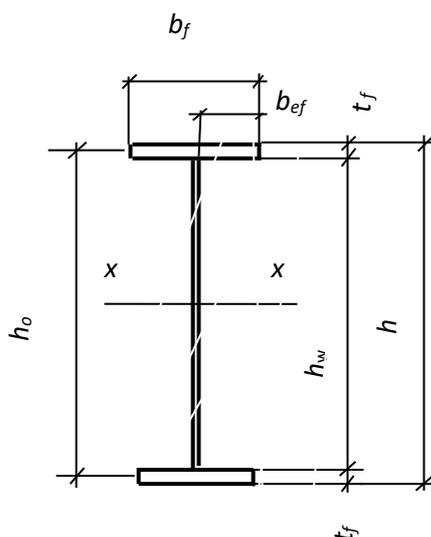
Рисунок 8.5. Сечение составной сварной балки.
