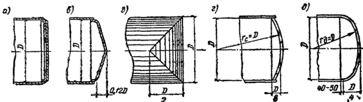
Рис.17.10. Типы днищ горизонтальных резервуаров
