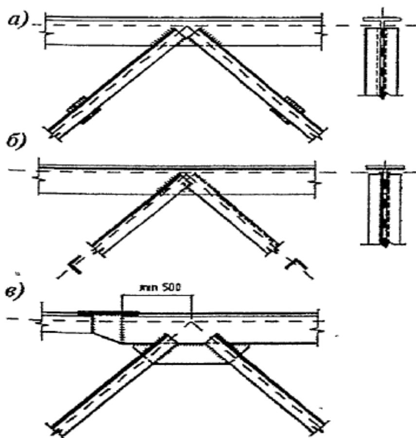
Рис. 10.14. Узлы ферм с поясами из широкополочных тавров: а) – с решеткой из парных уголков; б) – с решеткой из одиночных уголков, по разные стороны стенки тавра; в) – с фасонкой.
