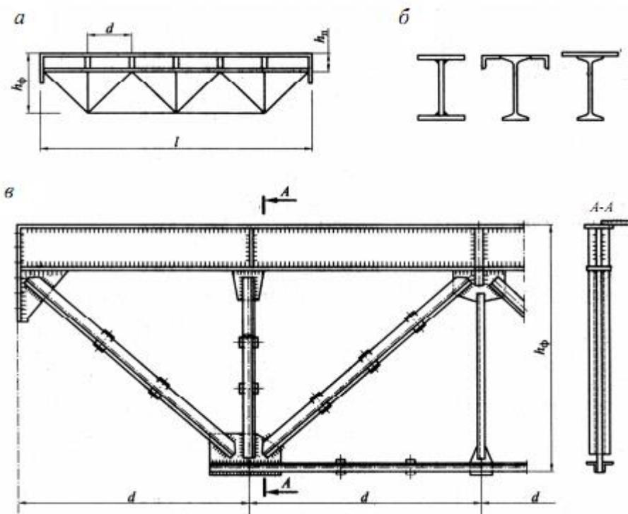
Рис. 16.9. Решетчатая подкрановая балка
