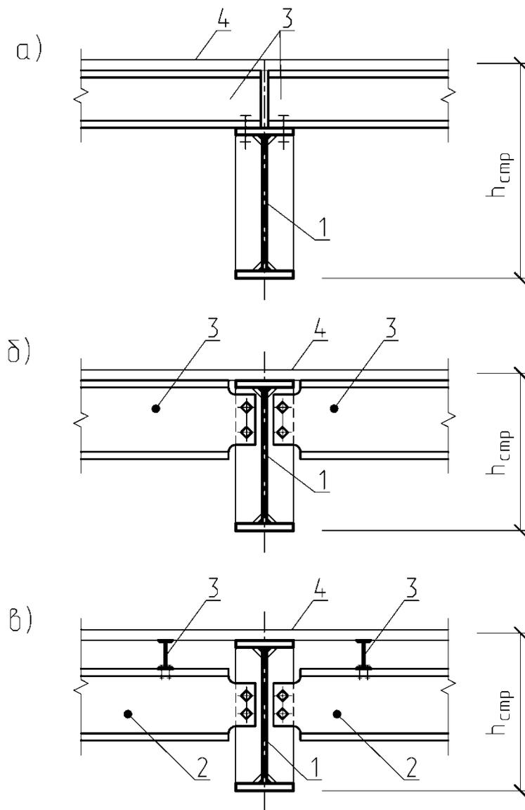
Рисунок 8.3. Схемы сопряжений балок:
