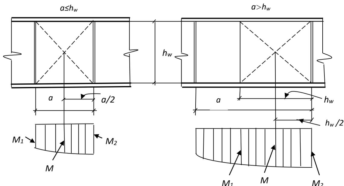
Рисунок 8.10. К определению расчетного изгибающего момента ( $M$  – расчетный изгибающий момент для отсека).
