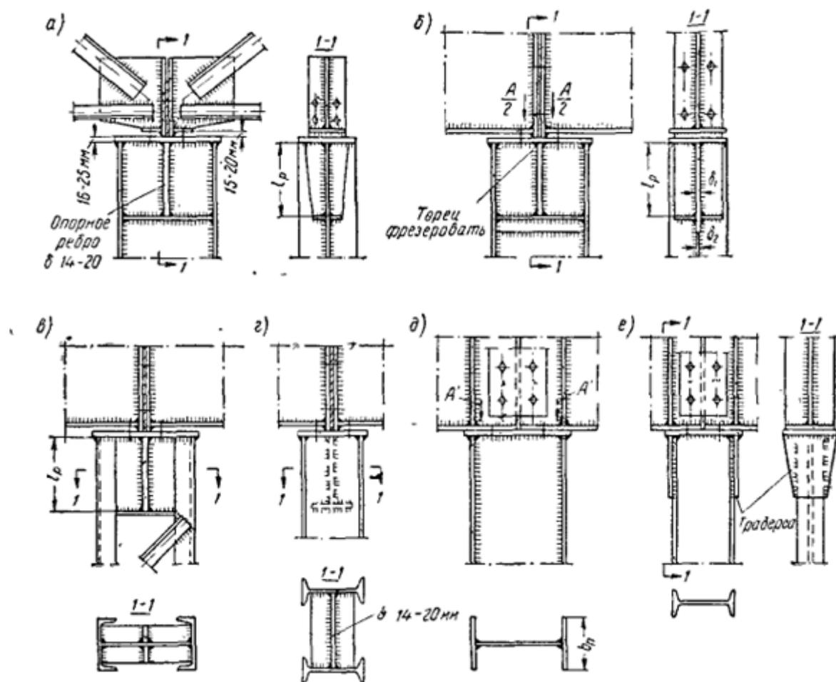
Рис. 9.12. Оголовки колонн при опирании конструкций сверху.
