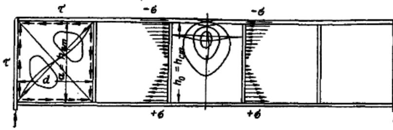
Рис. 8.8 б. Потеря местной устойчивости стенки от нормальных и касательных напряжений.
