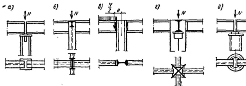
Рис. 9.2 Схемы сопряжения балок с колонной
