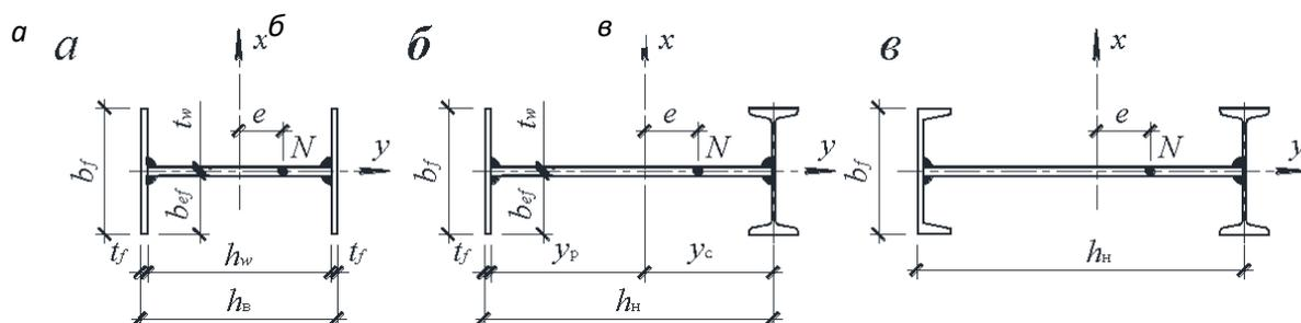
Рис. 14.5. Типы сечений сплошных колонн:
