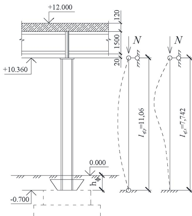
Рис. IX.1. К определению расчетной длины сплошной колонны
