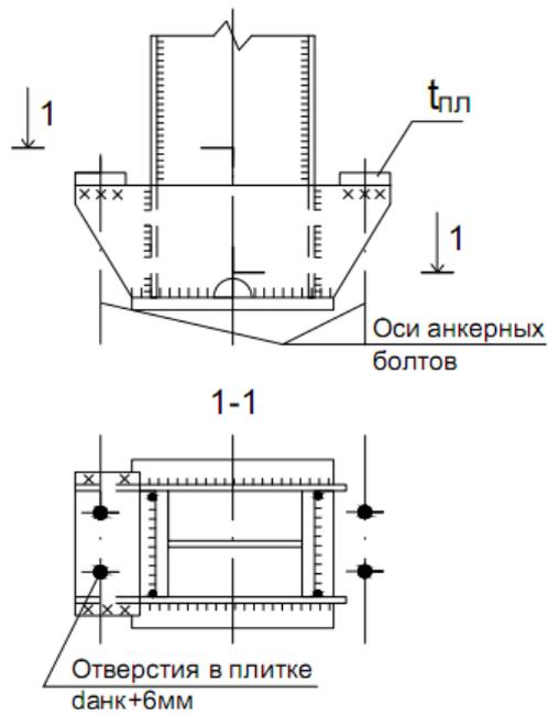
Рис. 14.13. База сплошной колонны постоянного по высоте сечения
