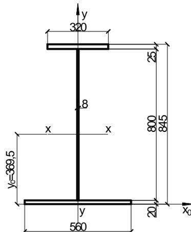
Рис. П. 2. Сечение балки
