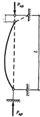
Рис. 3.3. Продольный изгиб центрально-сжатого стержня.
