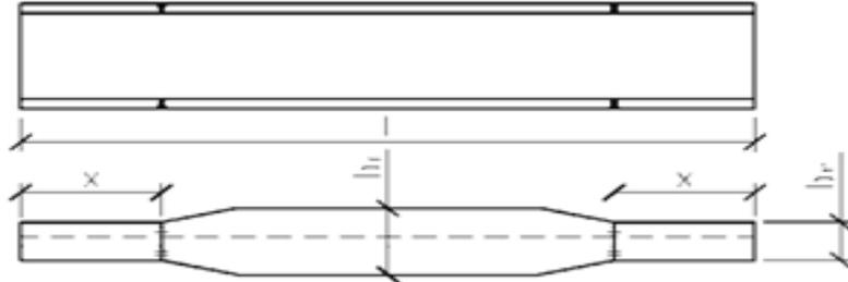
Предварительно назначаем расстояние от опоры балки до точки начала измерения сечения  $x = \frac{1}{6}l = \frac{1}{6}10,8 = 1,8\text{ м}$ .
