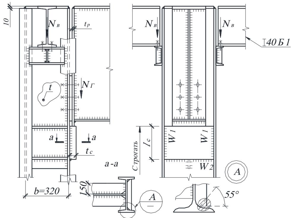
Рис. IX.6. Конструкция оголовка колонны сквозного сечения
