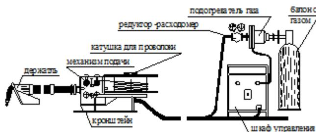
Рис. 2.10. Схема сварки полуавтоматом в защитном газе
