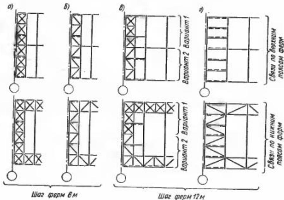
Рис 11.12. Схемы системы связей по покрытию
