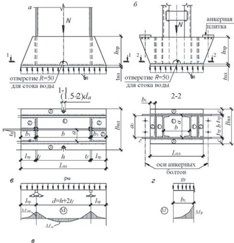
Рис. 9.11 Типы баз колонн:
