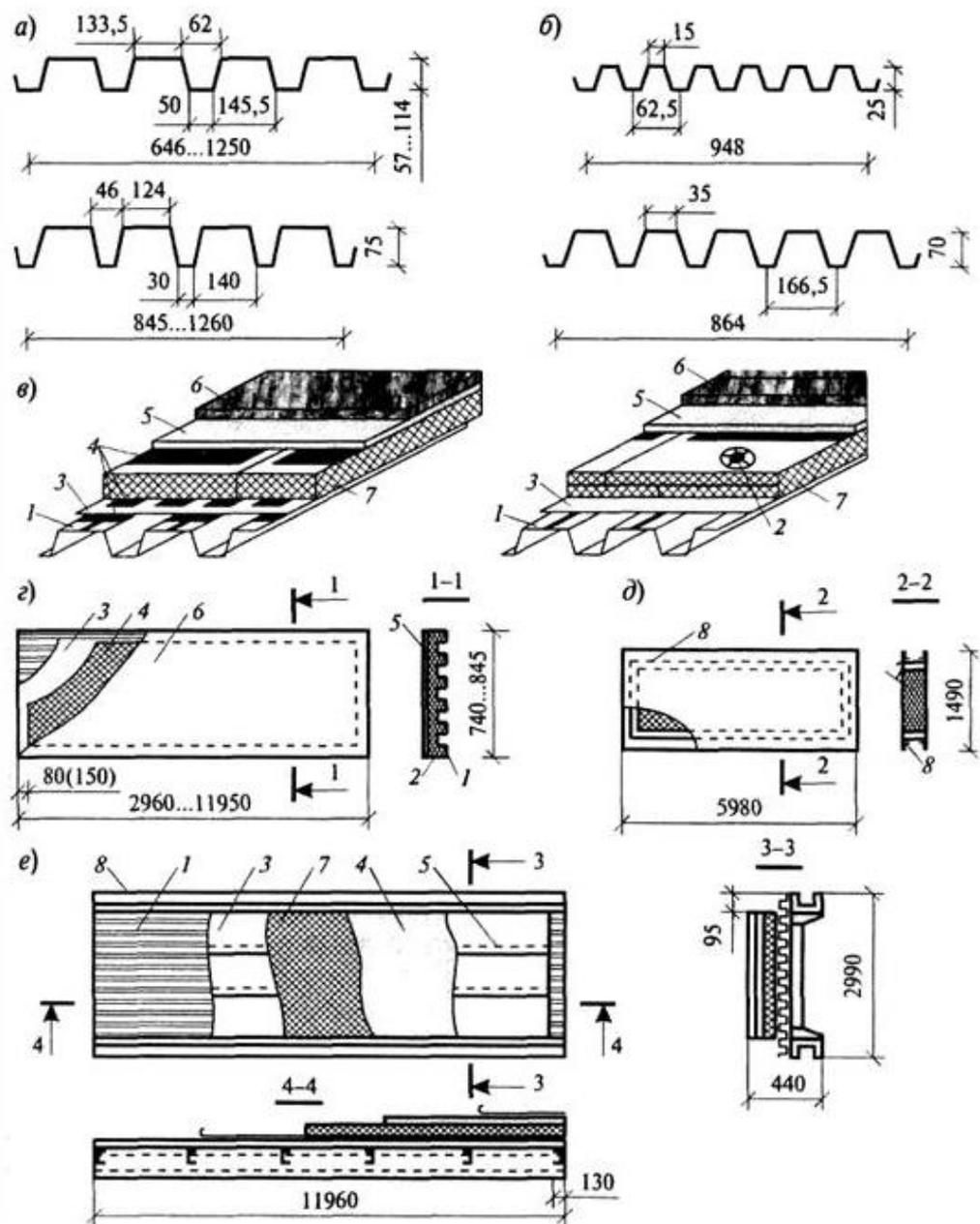
Рис. 13.2 Металлические ограждающие конструкции покрытий: а, б – стальные и алюминиевые профилированные листы; в – конструкция с послойной сборкой на клею и винтах; г – монопанель; д – трехслойная алюминиевая панель; е – трехслойная каркасная панель; 1 – профилированный настил; 2 – винтовое соединение; 3 – пароизоляция; 4 – битумная мастика; 5 – рулонная кровля; 6 – гравийно-защитный слой; 7 – утеплитель; 8 – каркас панели.
