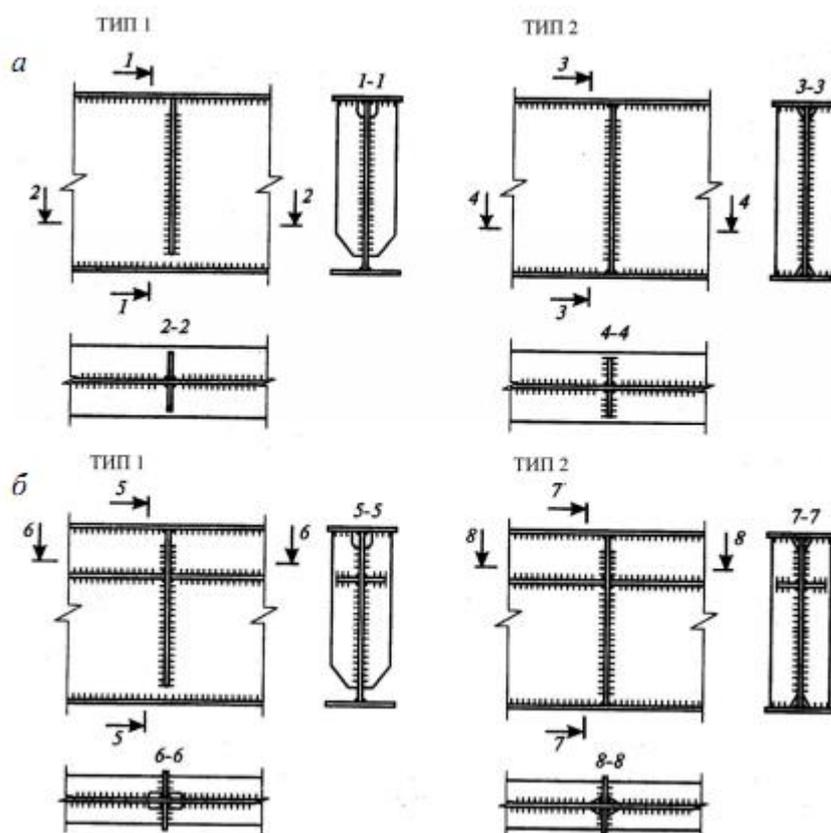
Рис.16.8 Ребра жесткости на сварных подкрановых балках:
