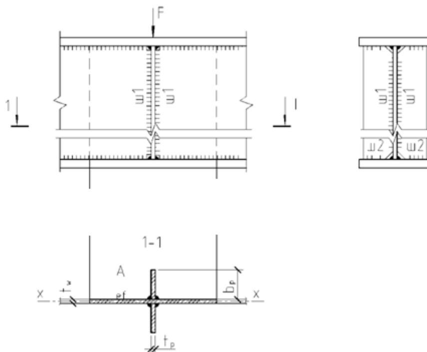
Рис. 8.11. Поперечные парные ребра жесткости.
