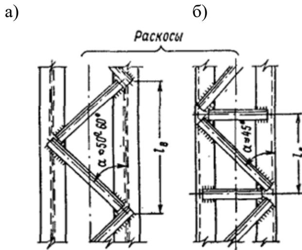
Рис. 9.7.(Начало рис.) Стержень колонны сквозного сечения а) – с треугольной решеткой; б) – треугольная с распорками;
