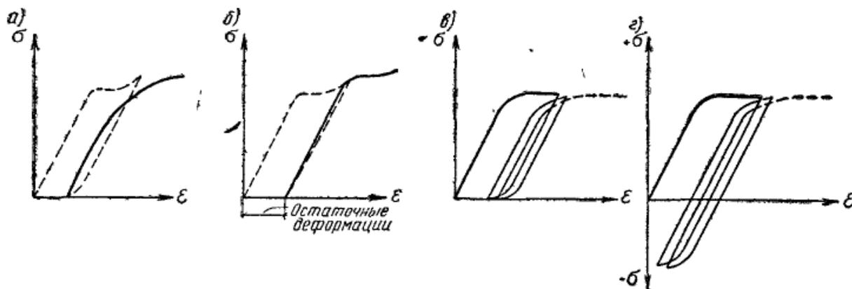
Рис. 2.7 Диаграммы деформирования стали при повторном нагружении: а) – при нагружении без перерыва ; б) – с перерывом (после отдыха); в) – многократное однозначное нагружение без перерыва; г) – многократное разнозначное нагружение.
