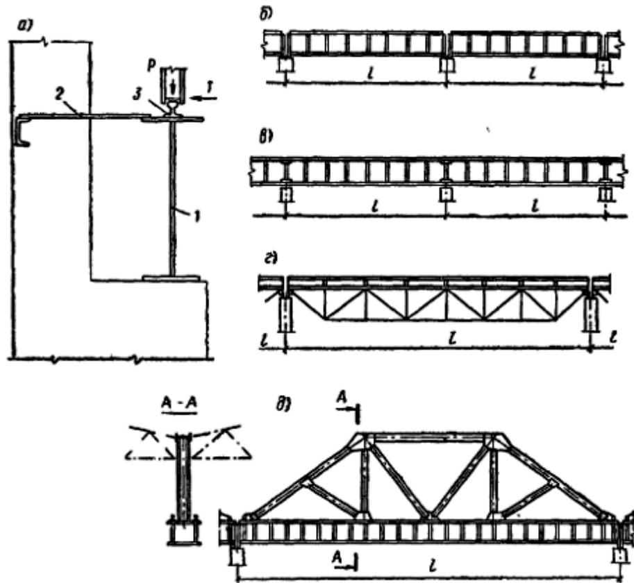
Рис. 16.1. Подкрановые конструкции
