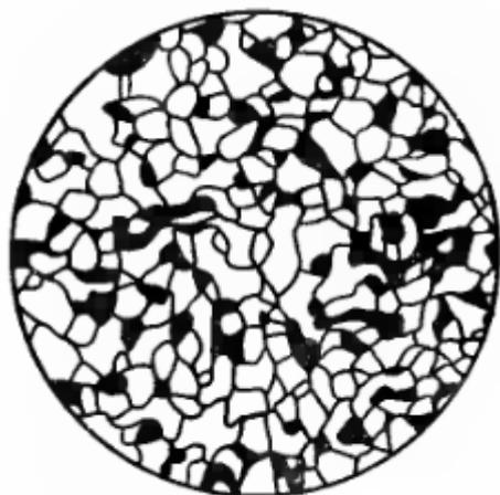
Рис 2.2 Микроструктура малоуглеродистой стали, полученная на шлифе (зерна феррита – светлая окраска, перлита и цементита – темная).
