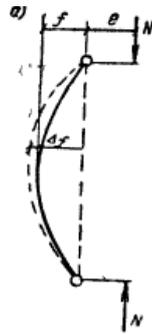
Рис. 3.4. Зависимость прогиба от нагрузки
