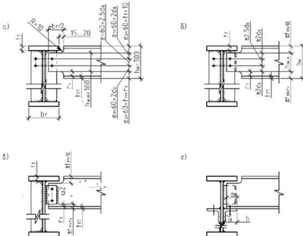
Рис.8.14. Шарнирные узлы сопряжений балок в одном уровне:
