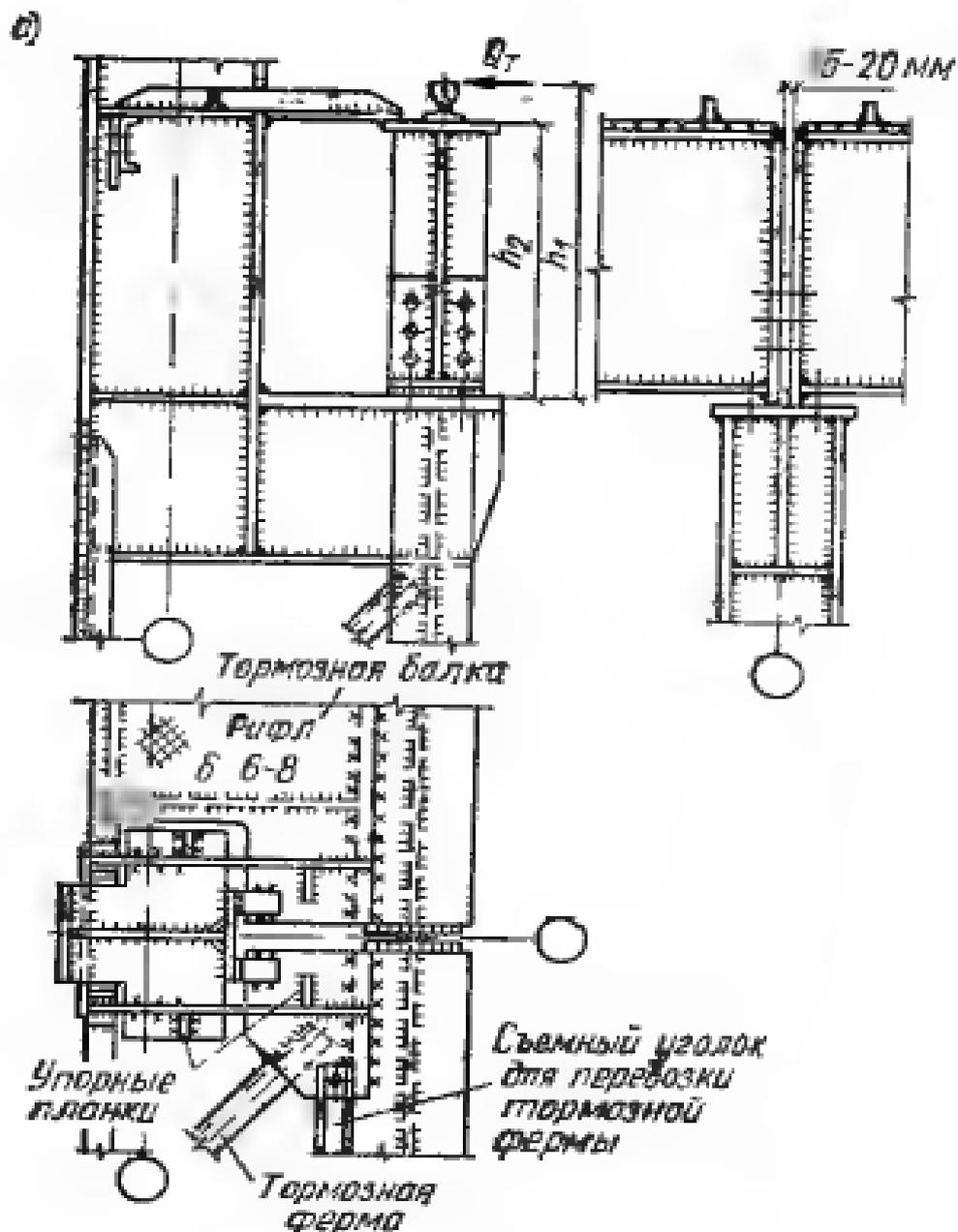
Рис. 16.11 Узел крепления балки к колонне
