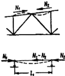
Рис. 10.7. К определению расчётной длины стержня с переменным осевым усилием.
