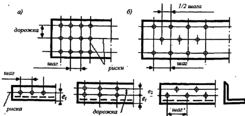
Рис. 5.8. Размещение болтов: а) рядовое; б) – шахматное.
