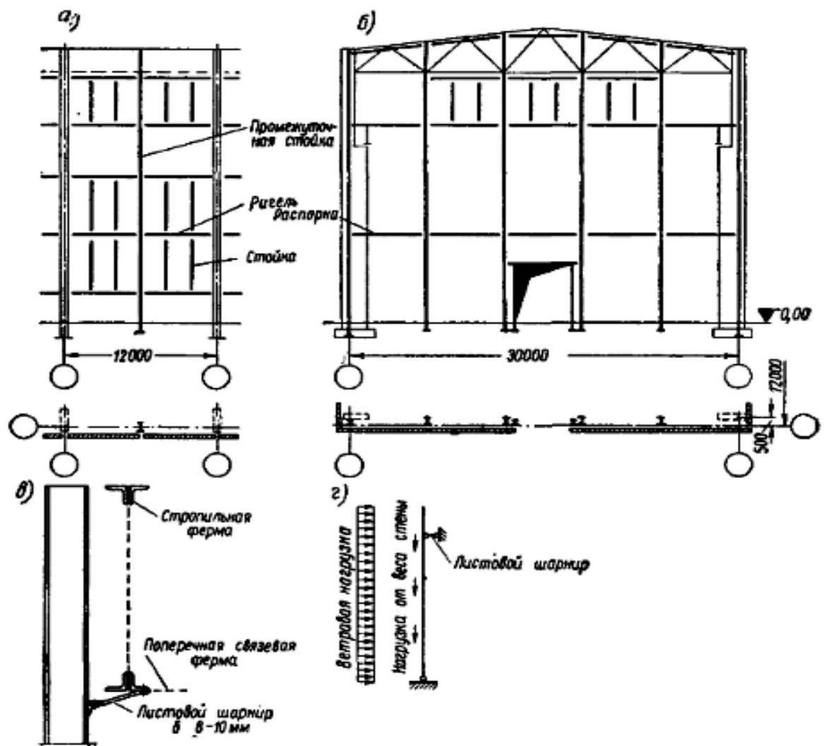
Рис. 15.1. Конструкция фахверка
