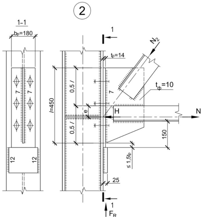
Рис. XIII.3. К расчету узла 2.
