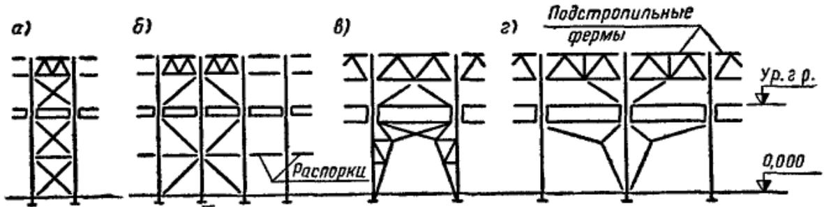
Рис. 11.9. Примеры схем вертикальных связей между колоннами
