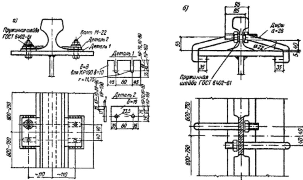
Рис.16.12. Крепление рельса к подкрановой балке
