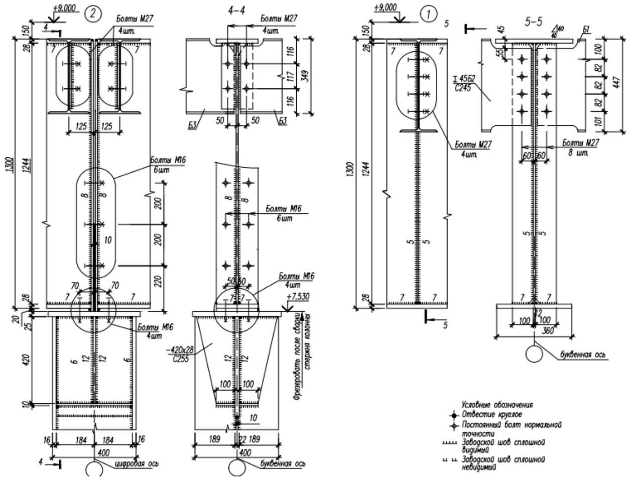
**Узел.2.** Вариант опирания балок настила БЗ на дополнительные ребра рядом с опорным ребром ГБ .
