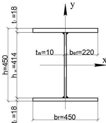
Рис. III. 1 Сечение стойки.
