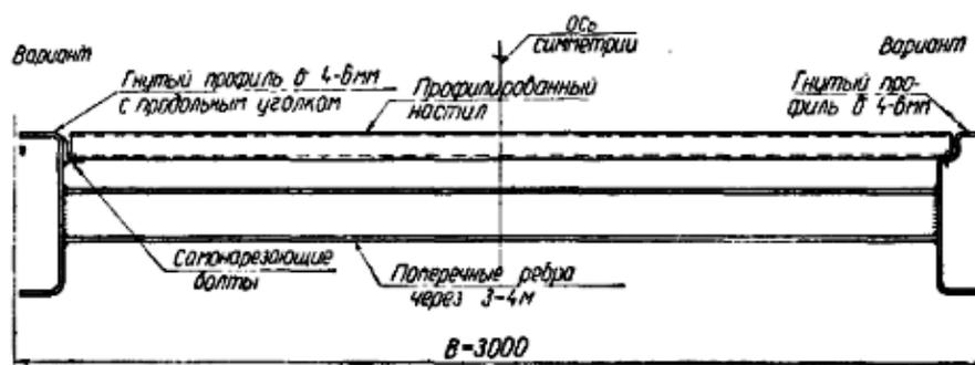
Рис. 13.6. Конструкция панели из гнутых профилей с профилированным настилом
