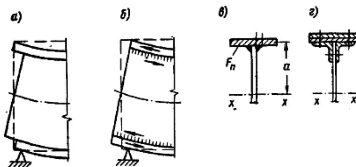
Рисунок 8.12. К расчету соединения поясов балок со стенкой
