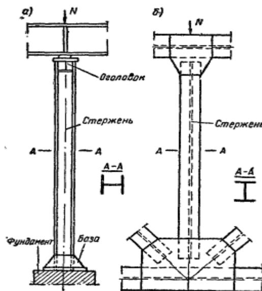
Рис.9.1 Элементы , работающие на центральное сжатие
