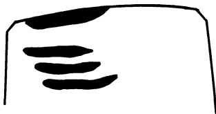
Рис. 2. Спектрограммы кинематической погрешности и зоны касания конических зубчатых пар ( z_1 = 12, z_2 = 41, m_{ге} = 8, \beta_n = 15^\circ ), шестерни которых обрабатывались: a, б – на станке мод. 25А27С4П; в, г – на станке мод. 5С270П до и после переборки дельтельной пары
