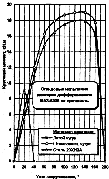
Рис. 3. Зависимость крутящего момента от угла закручивания при испытаниях шестерен дифференциала МАЗ
