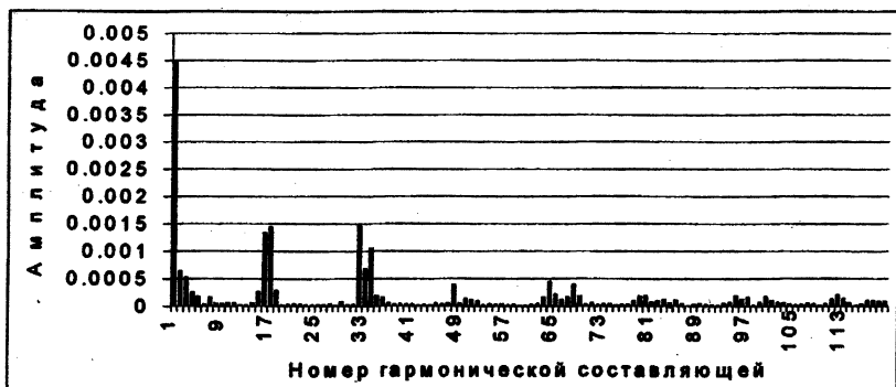
Рис.3. Амплитудно-частотный спектр кинематической погрешности собранной передачи с U=17
