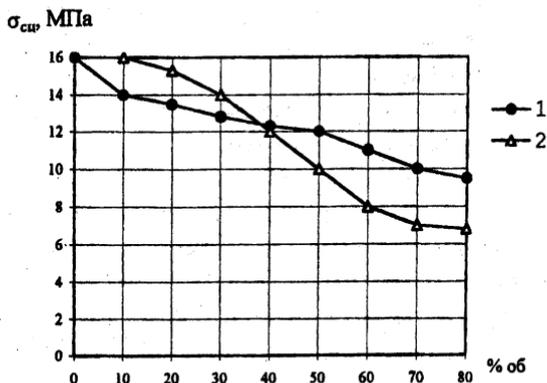
Рис. 2. Зависимость прочности сцепления от содержания карбидной фазы:
