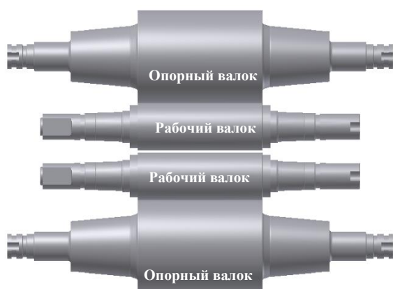
Рисунок 1 – Валковая система кварто
