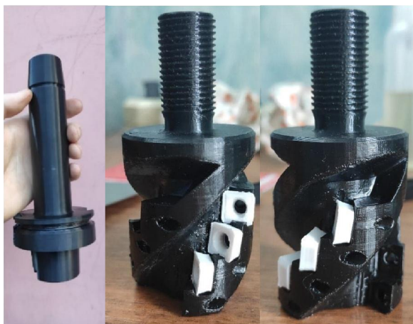
Рис. 4 а. 3D модель сборной торцово-цилиндрической фрезы; б. напечатанная модель на 3D принтере
