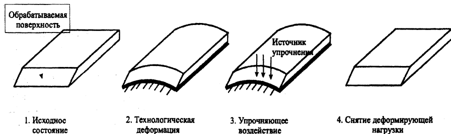
Рис. 1. Принципиальная схема упрочняющей обработки ножей с созданием регламентированного уровня остаточных напряжений.
