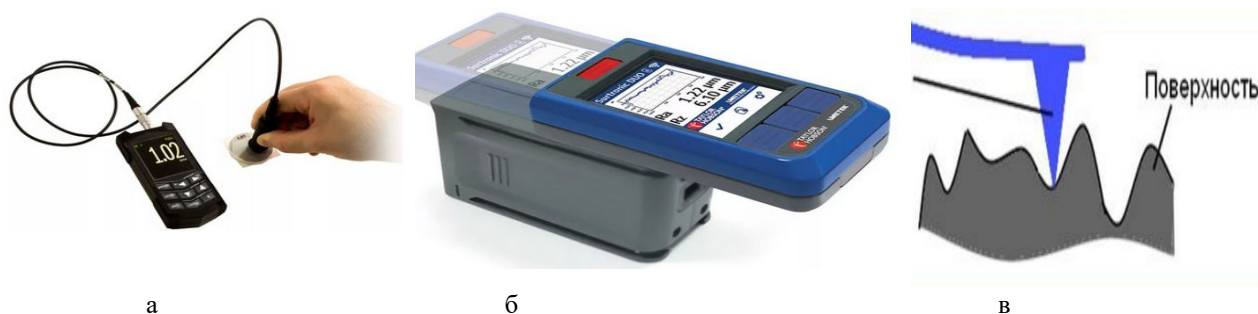
Рисунок 1 – Толщиномер (а), профилометр «Surtronic DUO» (б) и схема ошупывания обработанной металлической поверхности (в)
