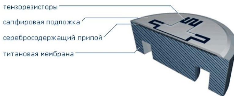
Рис. 1. Тензорезистивный датчик давления
