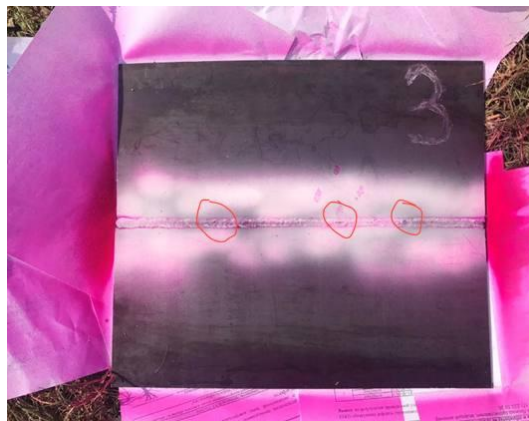
Рис. 1. Обнаружение дефектов с помощью капиллярного метода
