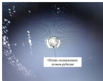
Рис. 1. Конический отражатель в вакуумной камере Рис. 2. Облако захваченных атомов рубидия
