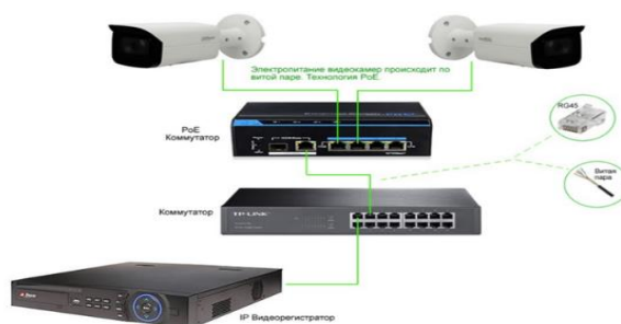
Рис. 1. Схема подключения IP-видеокамер по технологии PoE
