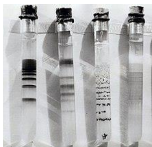
Рис. 2. Слои Лизеганга в пробирках
