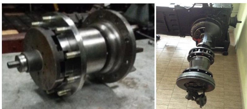
Рис. 1-Опорно-сцепное устройство задних сдвоенных колес трактора БЕЛАРУС класса 50 кН: а- макет для полевых испытаний кулачкового механизма отключения наружного колеса; б- лабораторная установка макета на полуоси трактора для учебных целей в БГАТУ, позволяющая улучшить агроэкологические свойства агрегата.
