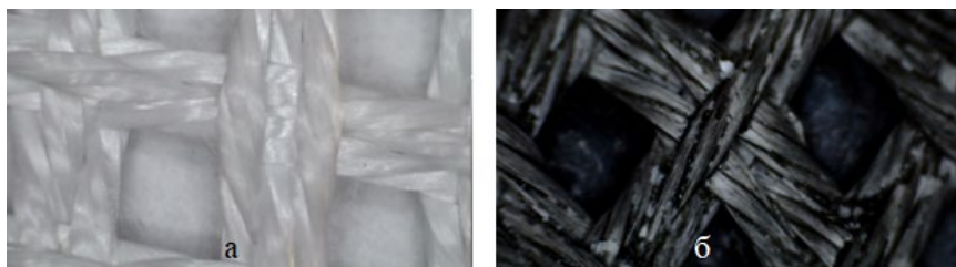
Рисунок 8 – Пропитанная сетка до (а) и после (б) проливки расплавом ВЧ50 (×40)
