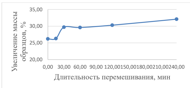
Рисунок 2 – Влияние длительности перемешивания на кроющую способность сиазит-20
