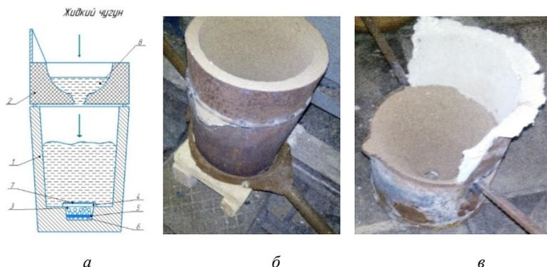
Рисунок 1 – Схема (а), общий вид ковша (б) и переходной крышки (в) для сфероидизирующего модифицирования ЧШГ (Tandish cover):
