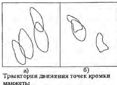
Рис. 3. Траектории движения точек кромки манжеты
