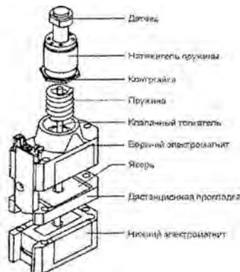
Рис. 2. Конструкция ЭМ клапана фирмы FEV-MT (Германия)
