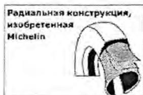
В брекерном слое шины расположены металлокордные ленты, нити корда которых направлены под острым углом к направлению вращения шины. Эти ленты накладываются попеременно в несколько слоев. Таким образом, основой упругой конструкции боковин шины является однослойный каркас, а основой конструкции брекерного слоя является жесткий "сэндвич", состоящий из части каркаса и металлокордных лент, нити корда которых образуют треугольник.
