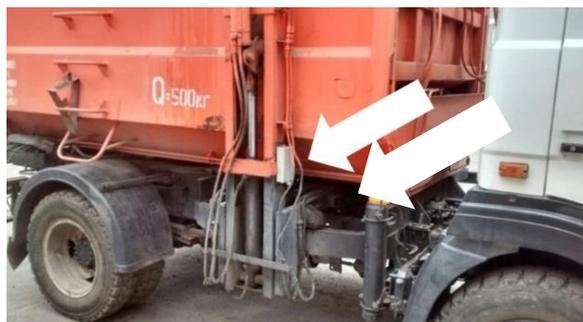
Рис. 1. Установка датчика угла наклона на мусоровоз
